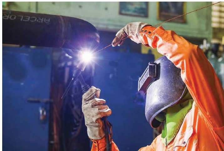
Slika 12. Ručno TIG zavarivanje
