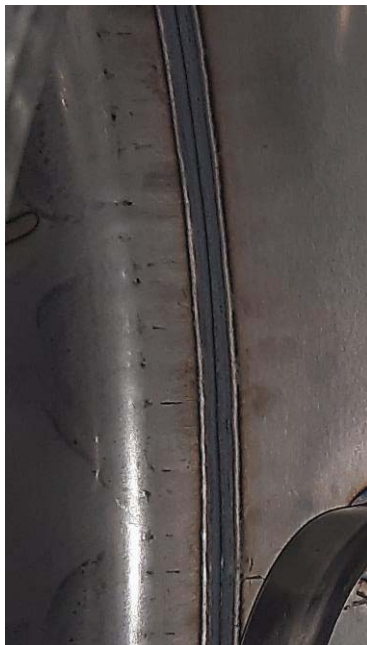
Slika 51. Korijen zavara plašta i podnice
