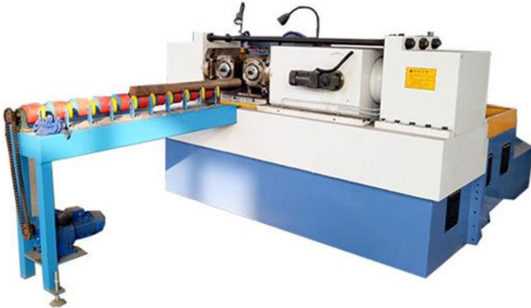
Slika 3.20 Automatski stroj za valjanje navoja [30]
