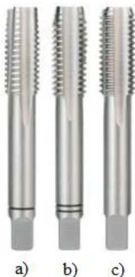
Slika 3.10. Ureznici za ručnu obradu [10]
