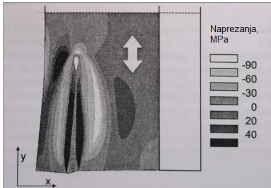
Slika 4.12 Primjer raspodjele naprezanja kod zavara sa pukotinom [19]
