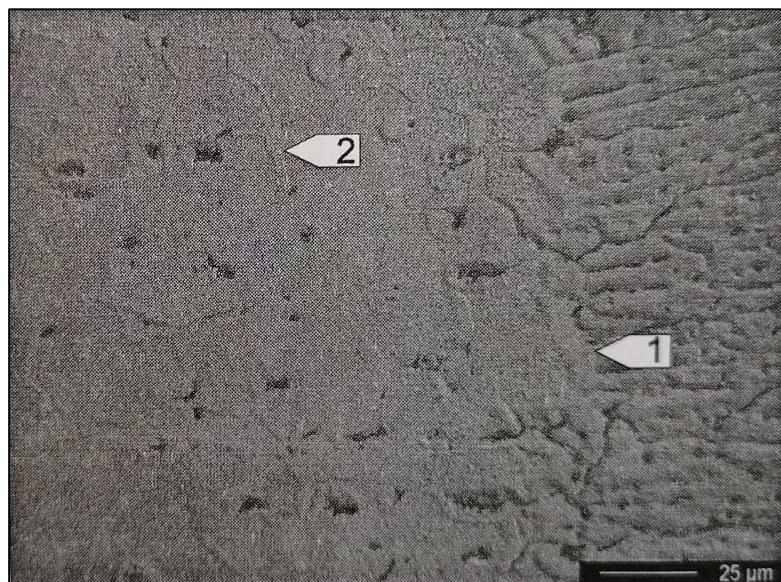
Slika 4.1 Poprečni presjek ruba zavara [16]
