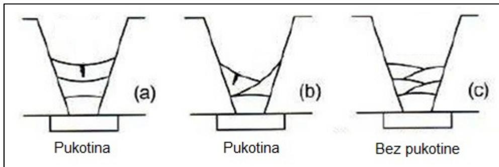
Slika 4.18 Pravilan oblik zavara kod višeslojnog zavarivanja [14]
