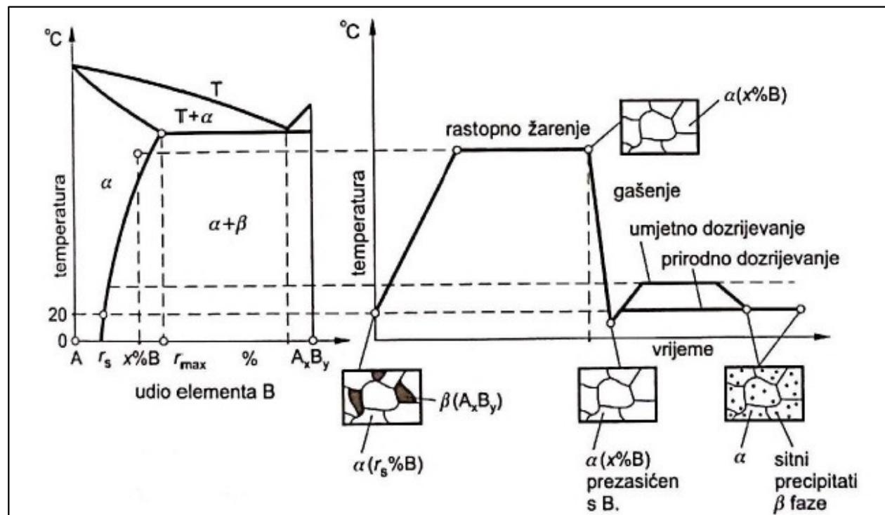
Slika 2.4 Dijagram stanja za precipitacijsko očvrsnuće [11]
