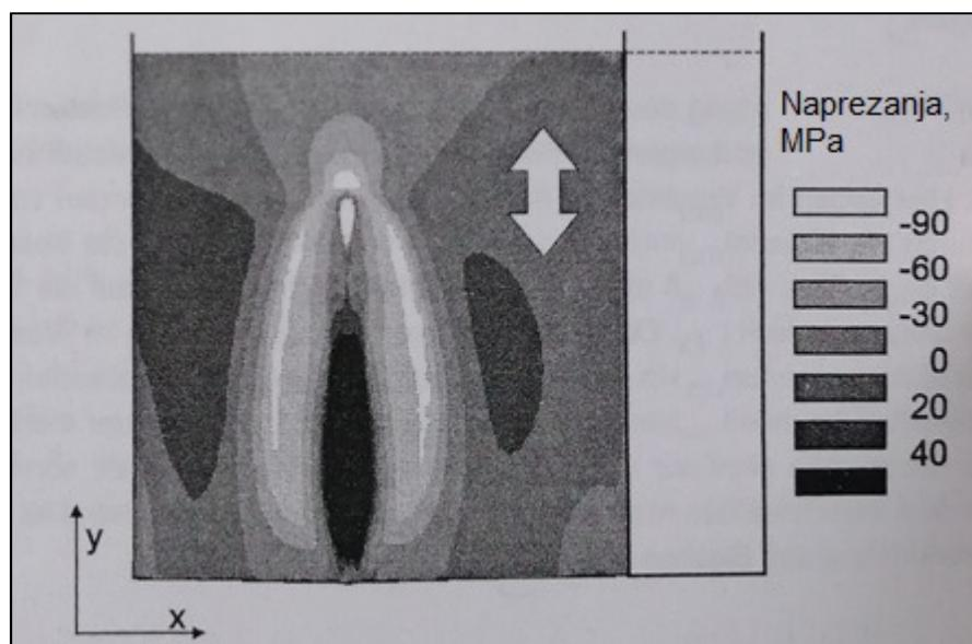
Slika 4.13 Primjer raspodjele naprezanja kod zavara bez pukotine [19]
