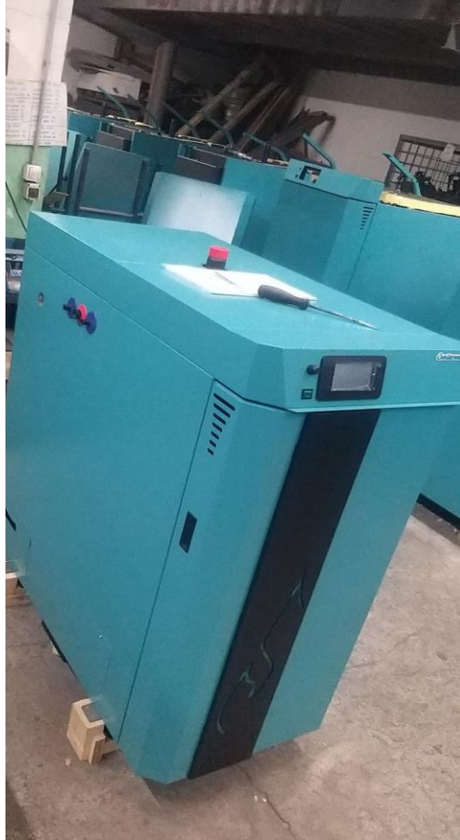
Slika 24. Toplovodni kotao BioTec [17]
