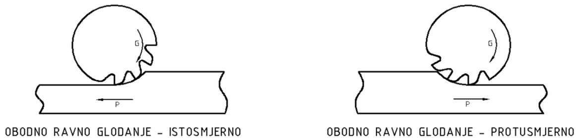
*Slika 3.5 Podjela glodanje prema kinematici postupka [9]*
