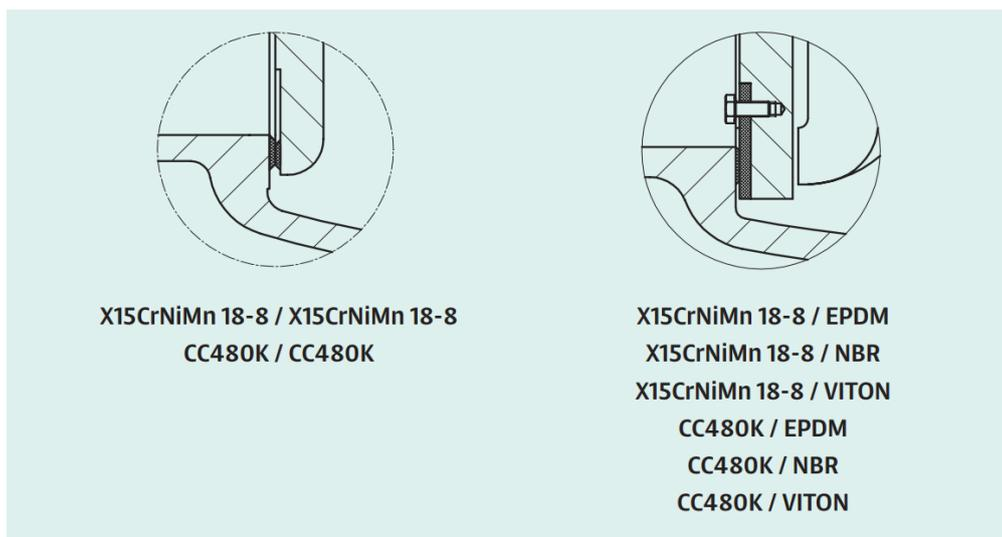
*Slika 2.2 Dva načina brtvljenja: metal-metal, metal-guma [11]*
