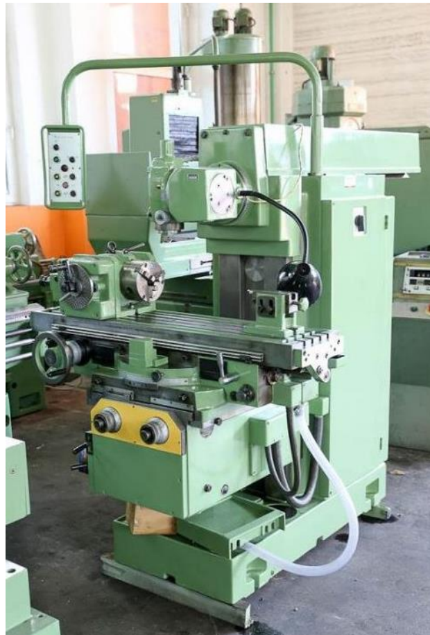
Slika 3.14 Glodalica Prvomajska GUK-1 s diobenim aparatom i šiljkom za podupiranje [15]
