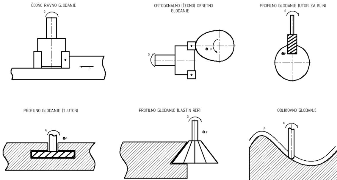
Slika 3.6 Podjela glodanje prema obliku obrađene površine [9]
