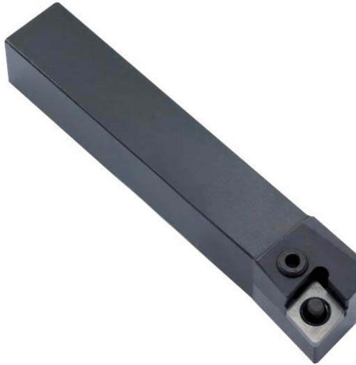
Slika 4.2 Tokarski nož (PCLNL 2525-M12)
