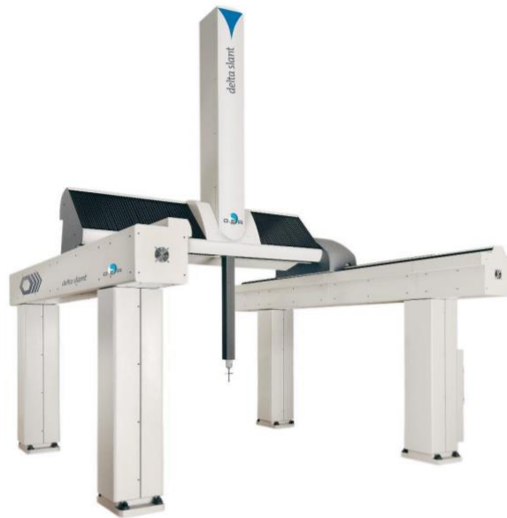
Slika 5. Portalni tip koordinatnog mjernog uređaja [5]
