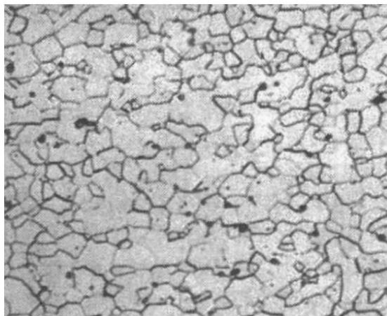
Slika 2.2 Mikrostruktura feritnog čelika (povećanje 100:1) [6]
