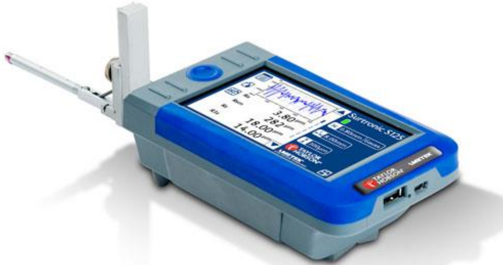
Slika 89. Uređaj AMETEK Taylor Hobson Surtronic S-100 Series
