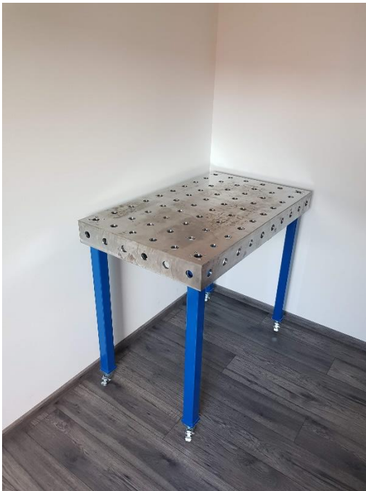
Slika 78. Završni izgled steznog stola za zavarivanje (1)
