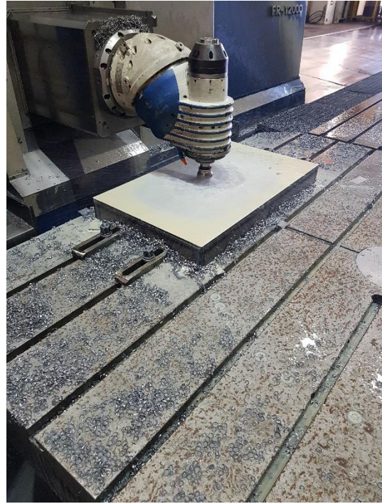
Slika 65. Čeono glodanje (završno) – 1. stezanje
