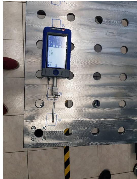
Slika 93. Mjerenje površinske hrapavosti na području 9
