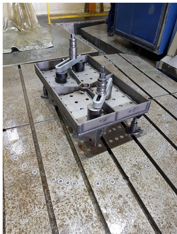
Slika 36. Priprema drugog stezanja
