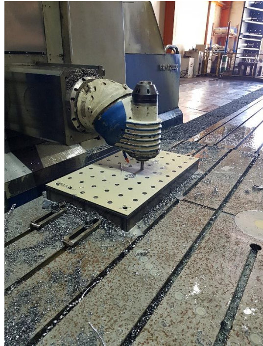
Slika 69. Istokarivanje provrta \varnothing 28H7 mm – 1. stezanje
