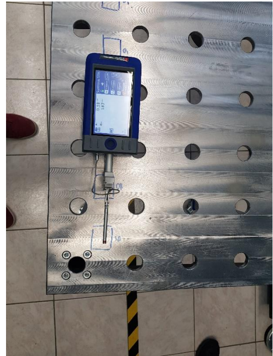
Slika 93. Mjerenje površinske hrapavosti na području 9
