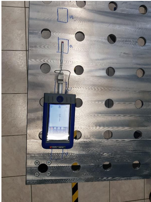
Slika 92. Mjerenje površinske hrapavosti na području 6
