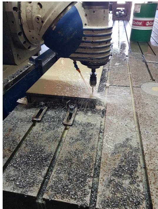
Slika 67. Bušenje provrta \varnothing 9 mm – 1. stezanje
