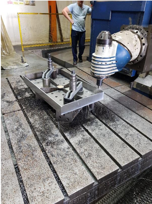
Slika 72. Čeono glodanje (grubo + završno) – 2. stezanje
