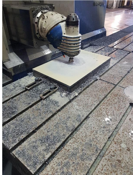
Slika 65. Čeono glodanje (završno) – 1. stezanje
