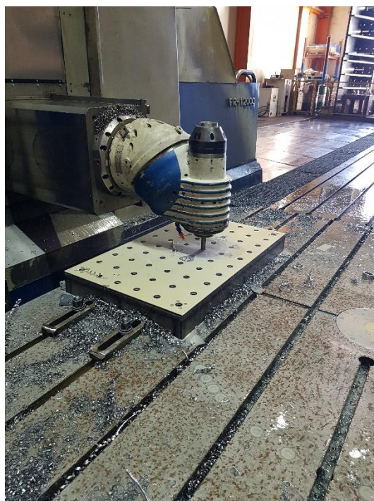
Slika 69. Istokarivanje provrta \varnothing 28H7 mm – 1. stezanje
