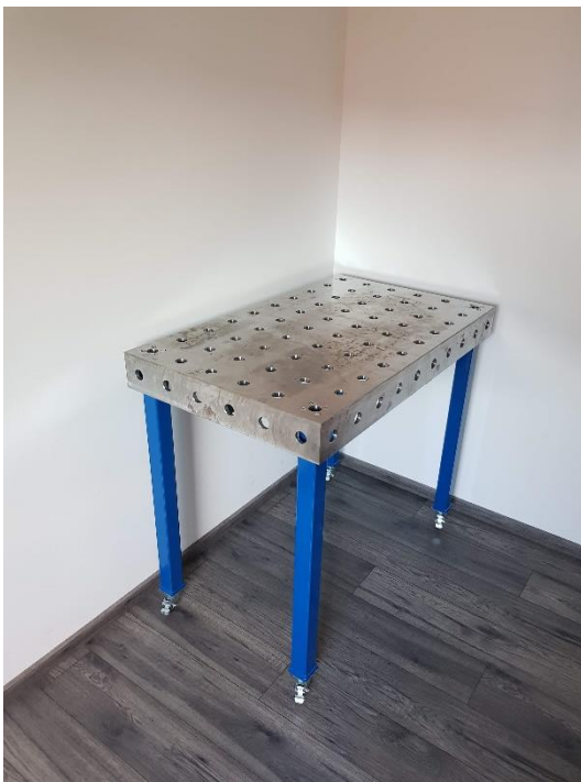
Slika 78. Završni izgled steznog stola za zavarivanje (1)
