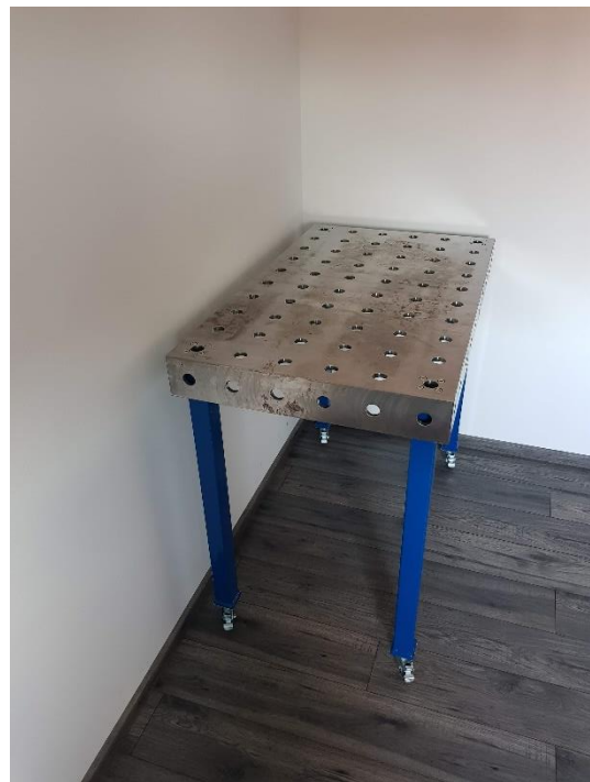
Slika 79. Završni izgled steznog stola za zavarivanje (2)
