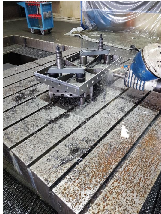
Slika 77. Glodanje bridova 2/45^\circ - 2. stezanje
