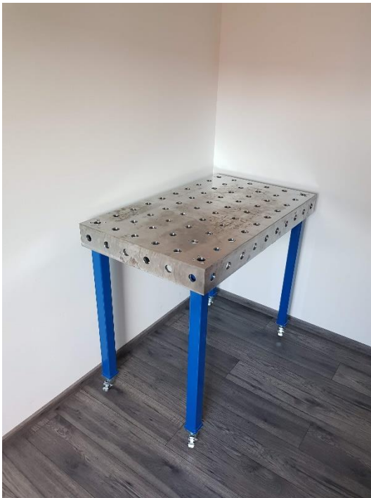
Slika 78. Završni izgled steznog stola za zavarivanje (1)
