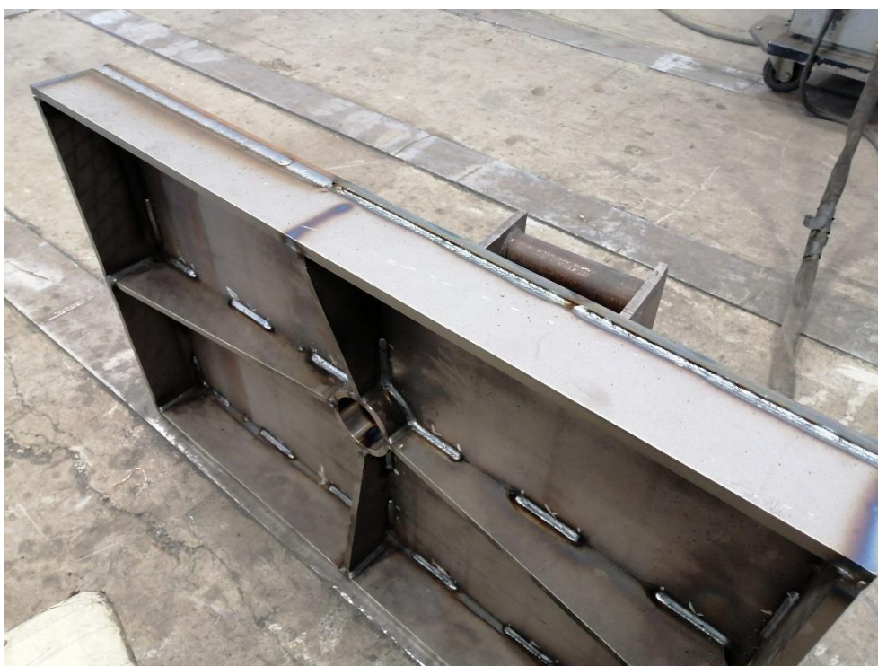
Slika 32. Izvedba HY zavora na steznom stolu za zavarivanje
