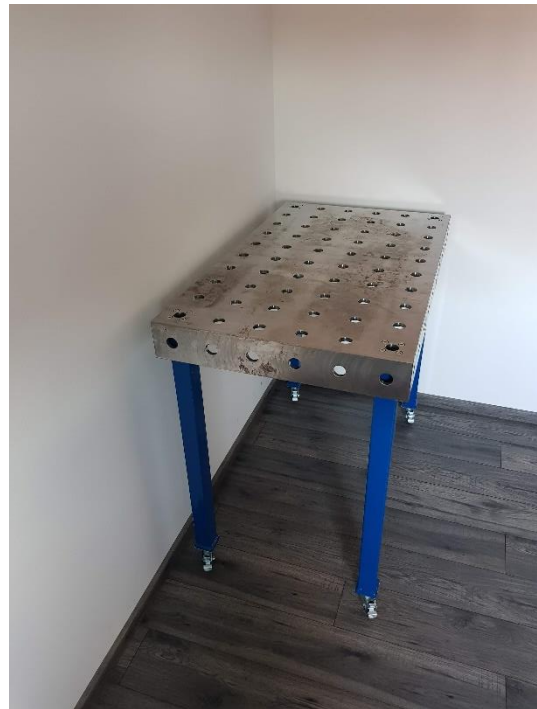
Slika 79. Završni izgled steznog stola za zavarivanje (2)
