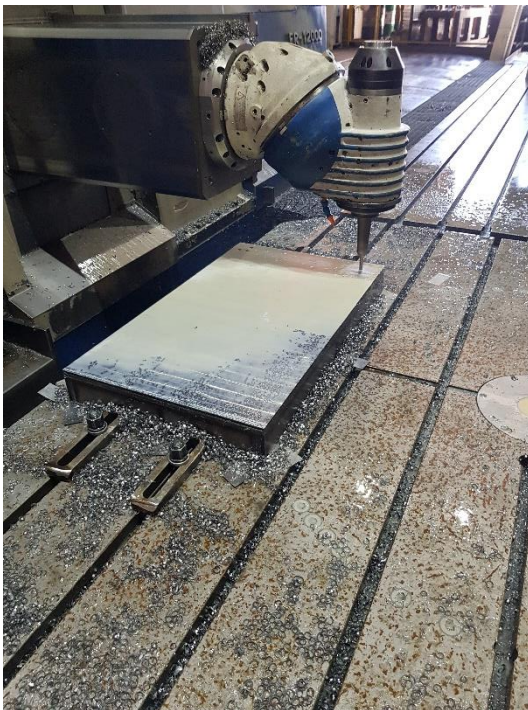
Slika 66. Bušenje upuštenja \text{Ø}14 mm – 1. stezanje
