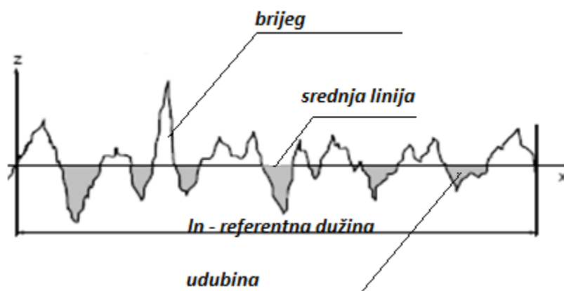
Slika 86. Određivanje srednje linije hrapavosti oblika [19]
