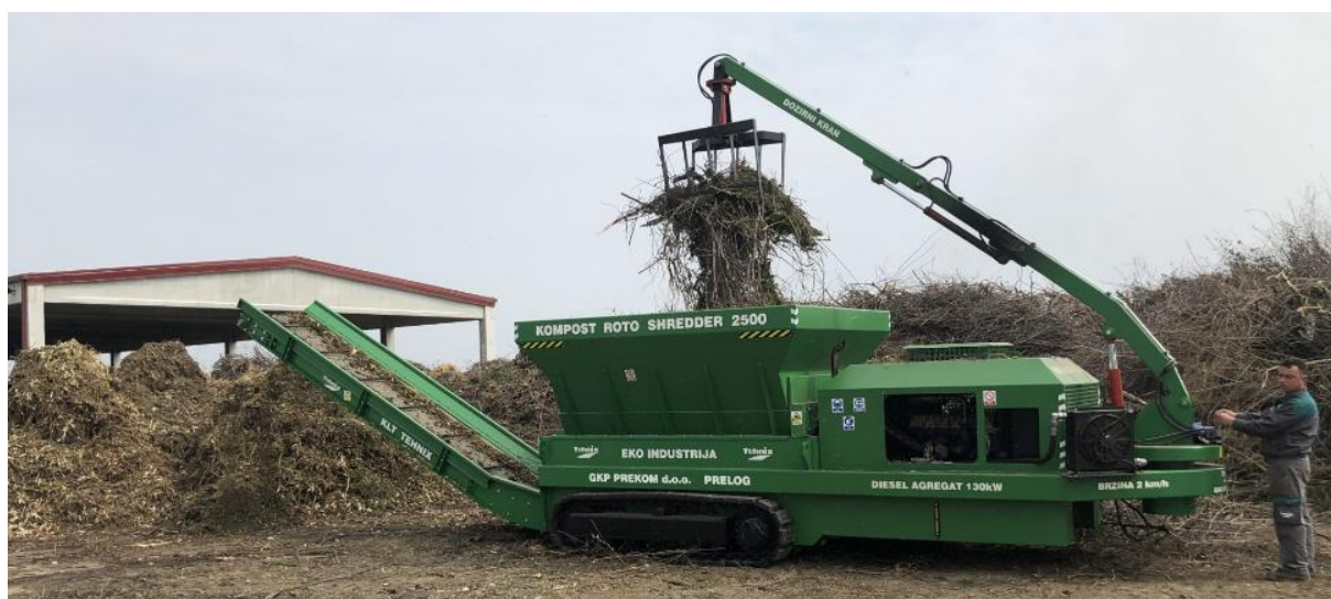
Slika 22. Kompost roto shredder [23]
