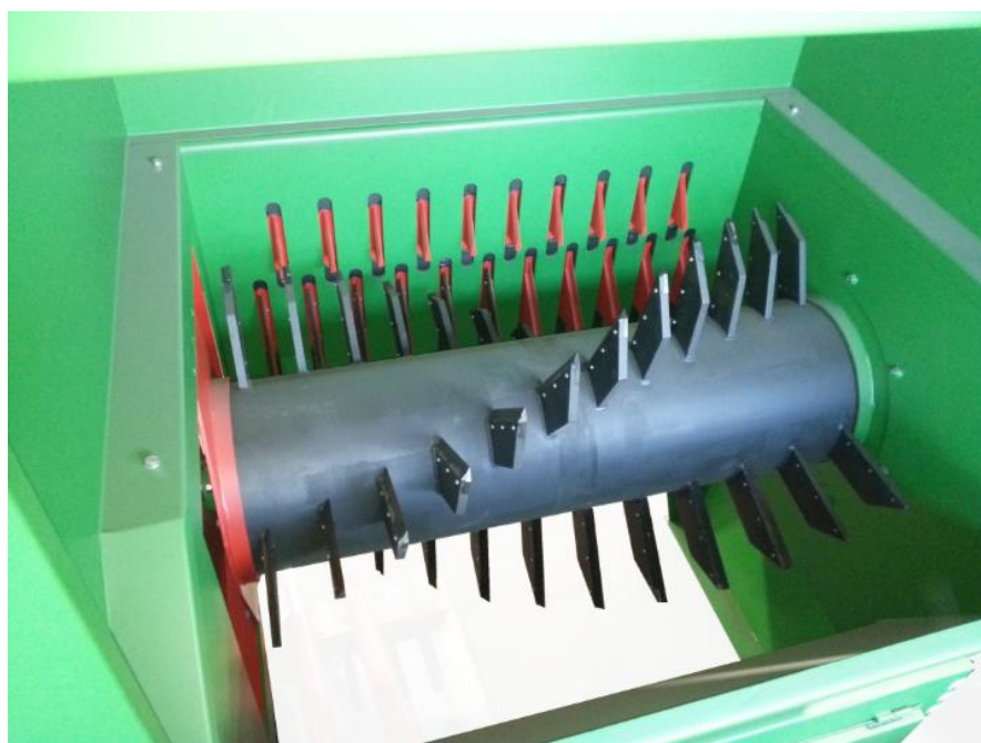
Slika 14. Noževi u stroju za otvaranje vreća [22]
