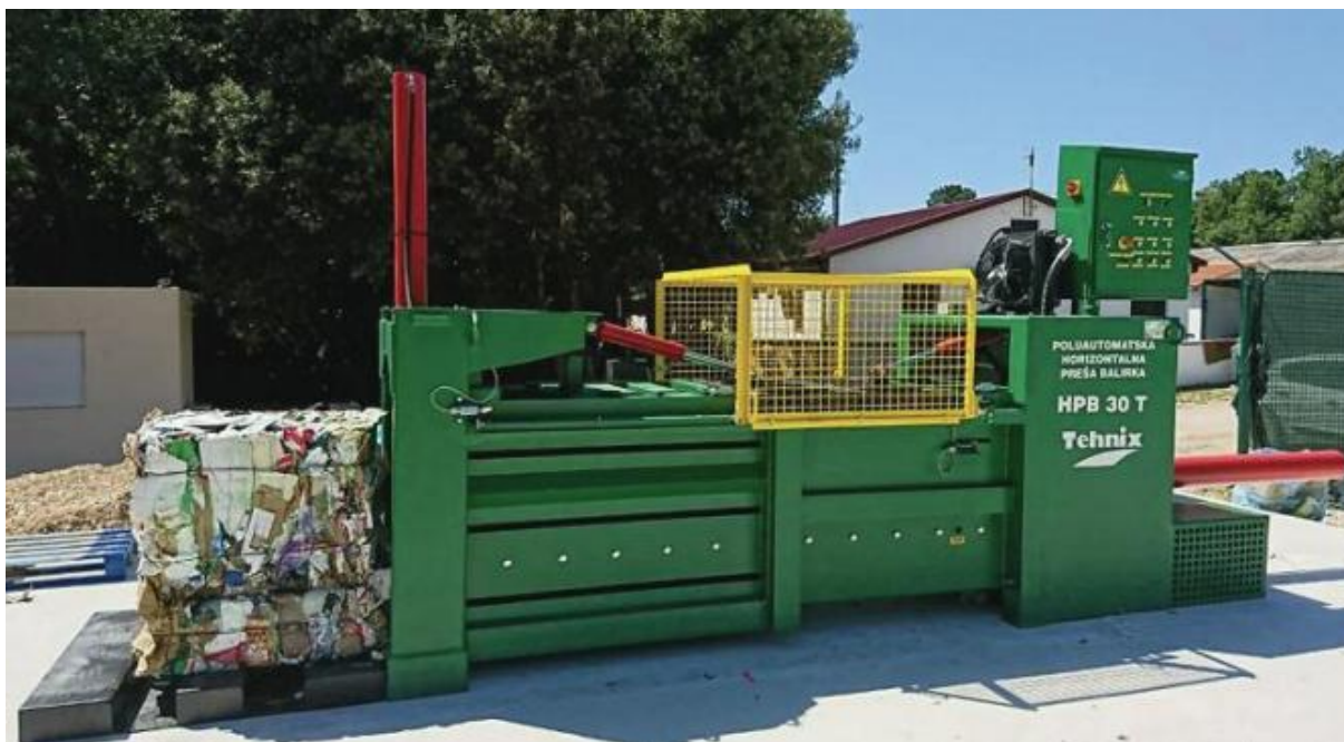
Slika 21. Horizontalna preša (HPB) [22]
