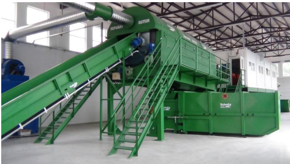
Slika 16. Separator rotor s kontejnerom ispod njega [23]
