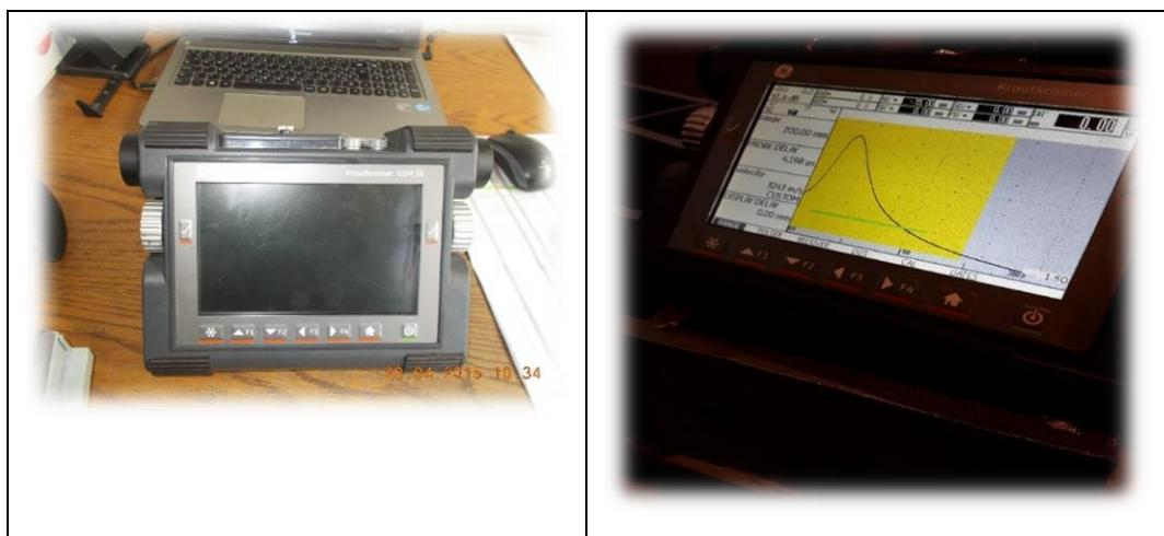
Slika 19. Uređaj za ultrazvučno ispitivanje Krautkramer USM 36
