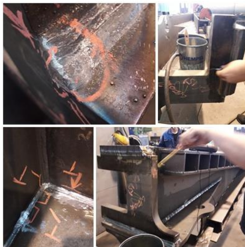
Slika 30. Vizualna kontrola i 1. faza ispitivanja
