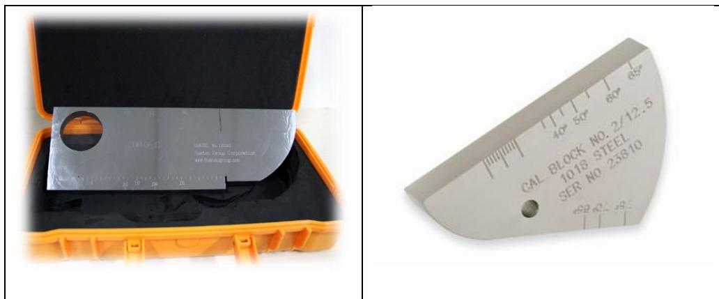
Slika 14. Kalibracijski blok K1 [4]
