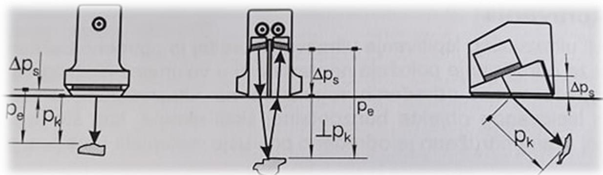
Slika 9. Shematski prikaz vremena kašnjenja u kontaktnoj tehnici [5]
