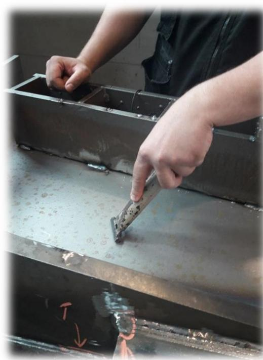
Slika 22. Čišćenje površine prije ispitivanja [4]
