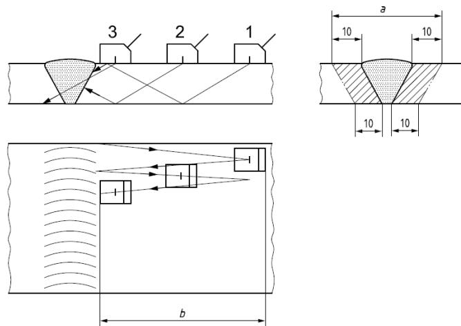
Slika 16. Ispitivanje površine zavara prema EN ISO 17640 [4]
