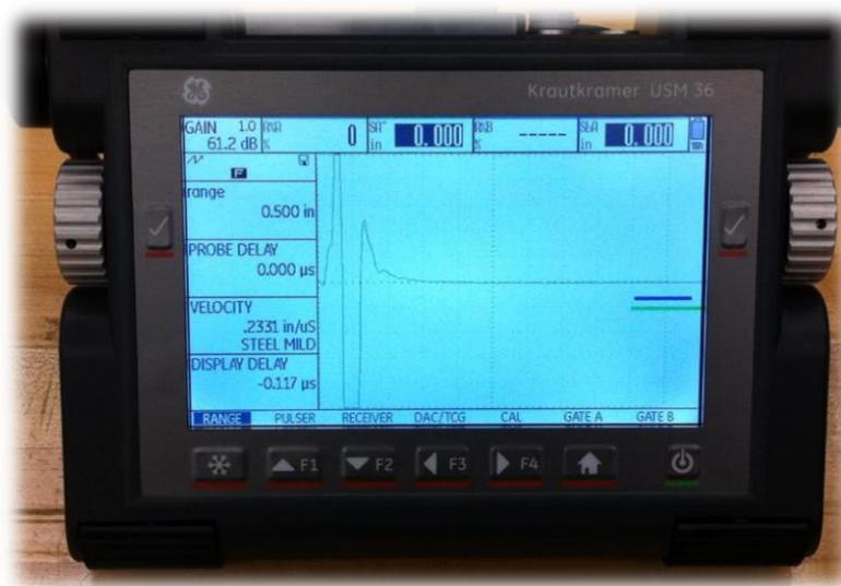
Slika 8. Ultrazvučni aparat Krautkramer USM 36 [4]
