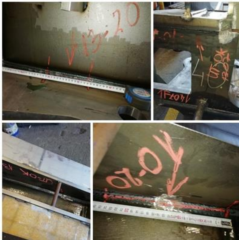
Slika 32. Oznake ispravnosti i grešaka na SPOKE-u [4]
