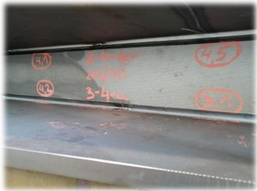
Slika 27. Označavanje i mjerjenje faza prije zavarivanja
