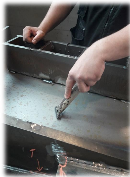
Slika 22. Čišćenje površine prije ispitivanja [4]
