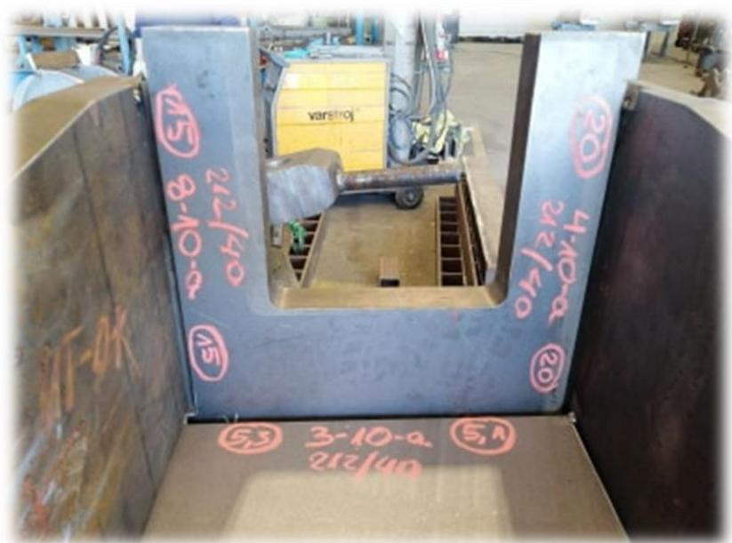
Slika 28. Označavanje i mjerjenje faza prije zavarivanja
