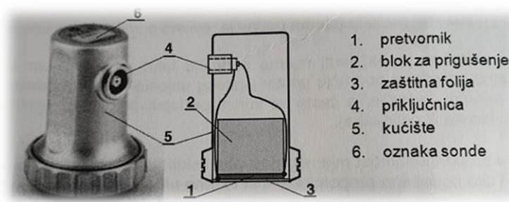
Slika 10. Shematski prikaz ravne sonde [5]
