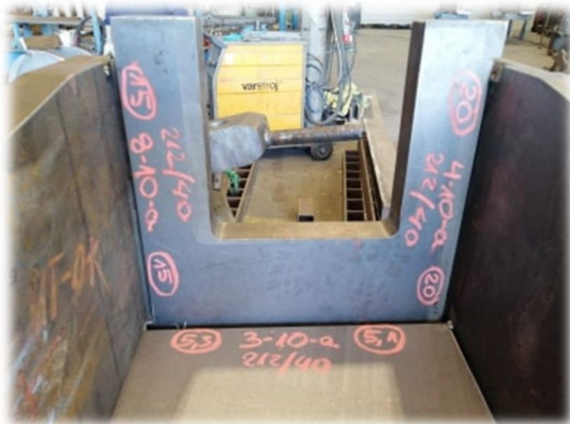
Slika 28. Označavanje i mjerenje faza prije zavarivanja
