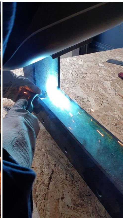
Slika 71. Zavarivanje pozicija konzolne potpore
