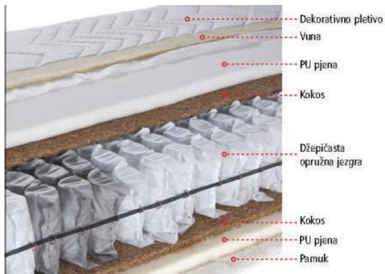
Slika 5. presjek madraca sa džepičastom jezgrom i PU pjenom
