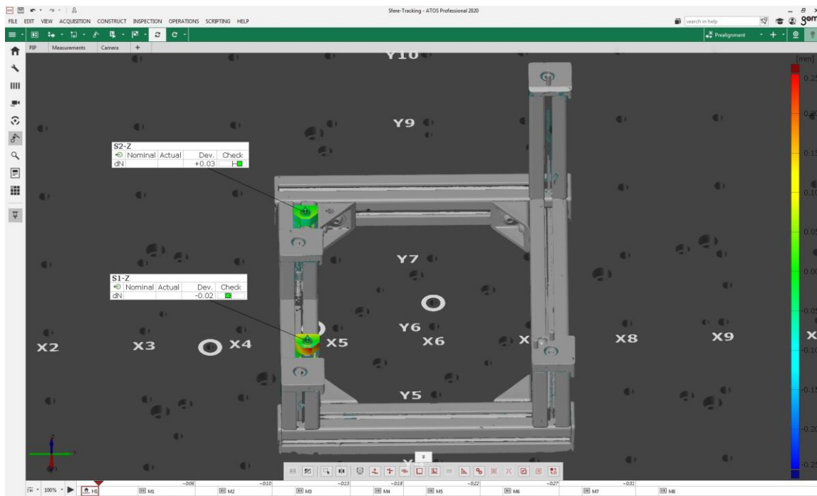
Slika 2-14 Rezultat optičkog pozicioniranja magnetnih sfera
