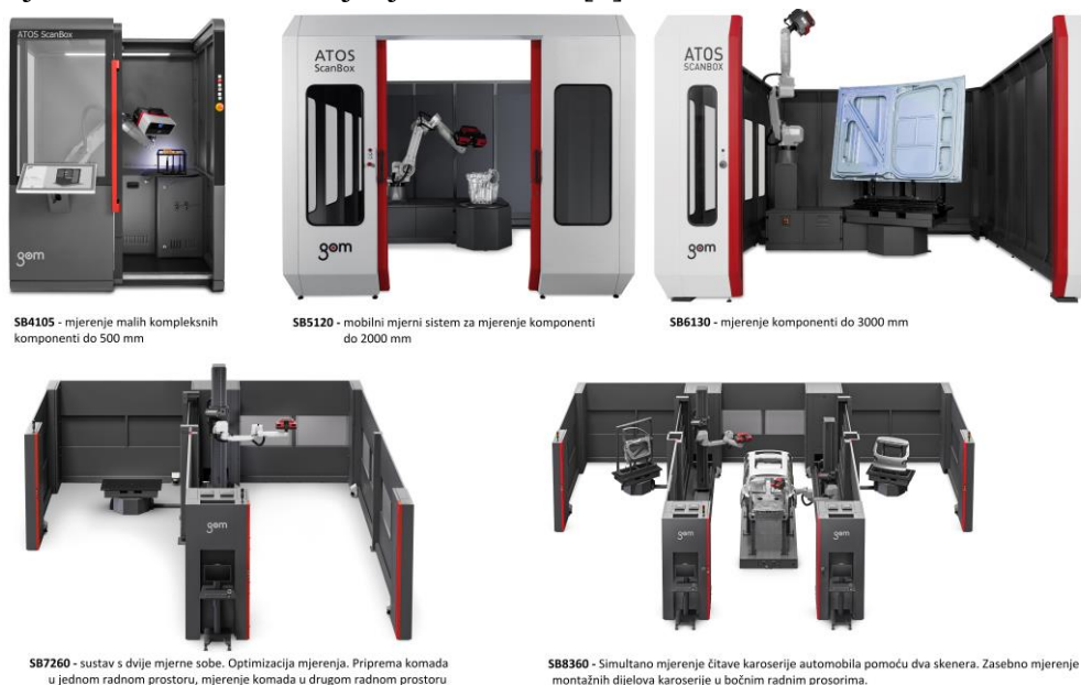
Slika 1-10 ATOS ScanBox mjerne ćelije [3]
