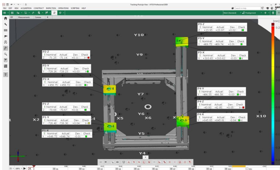
Slika 2-13 Rezultat optičkog pozicioniranja pokrova aluminijskih profila
