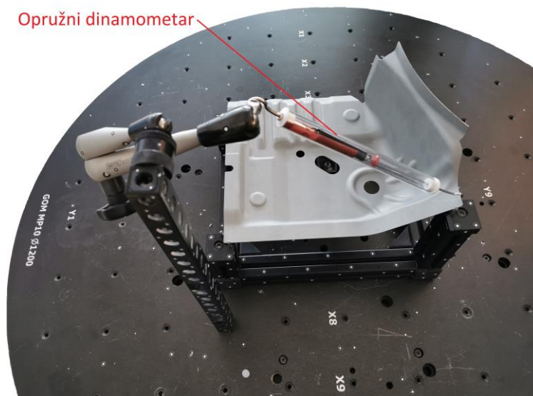
Slika 3-9 Lim opterećen dinamometrom
