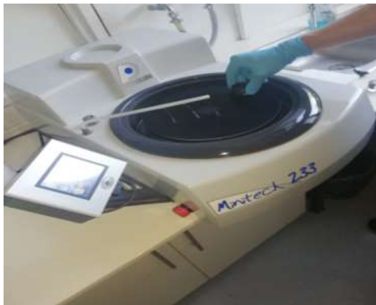
Slika 35. Uređaj za brušenje uzoraka- Presi
