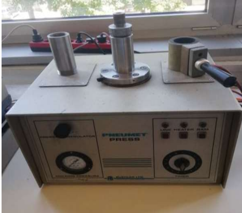
Slika 19. Uređaj za zalijevanje uzoraka u polimernu masu- Pneumat Press
