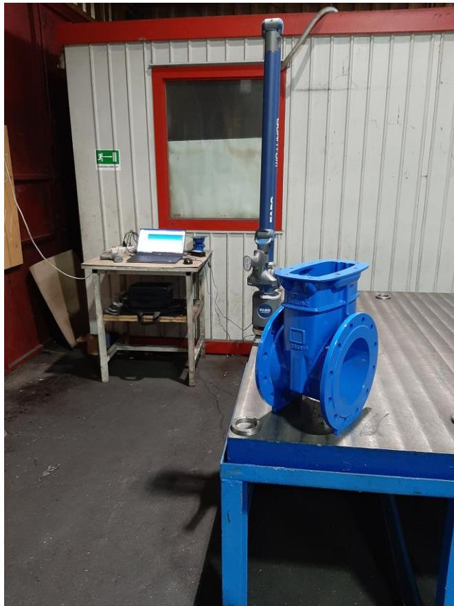
Slika 6.5. Mjerna ruka spremna za korištenje
