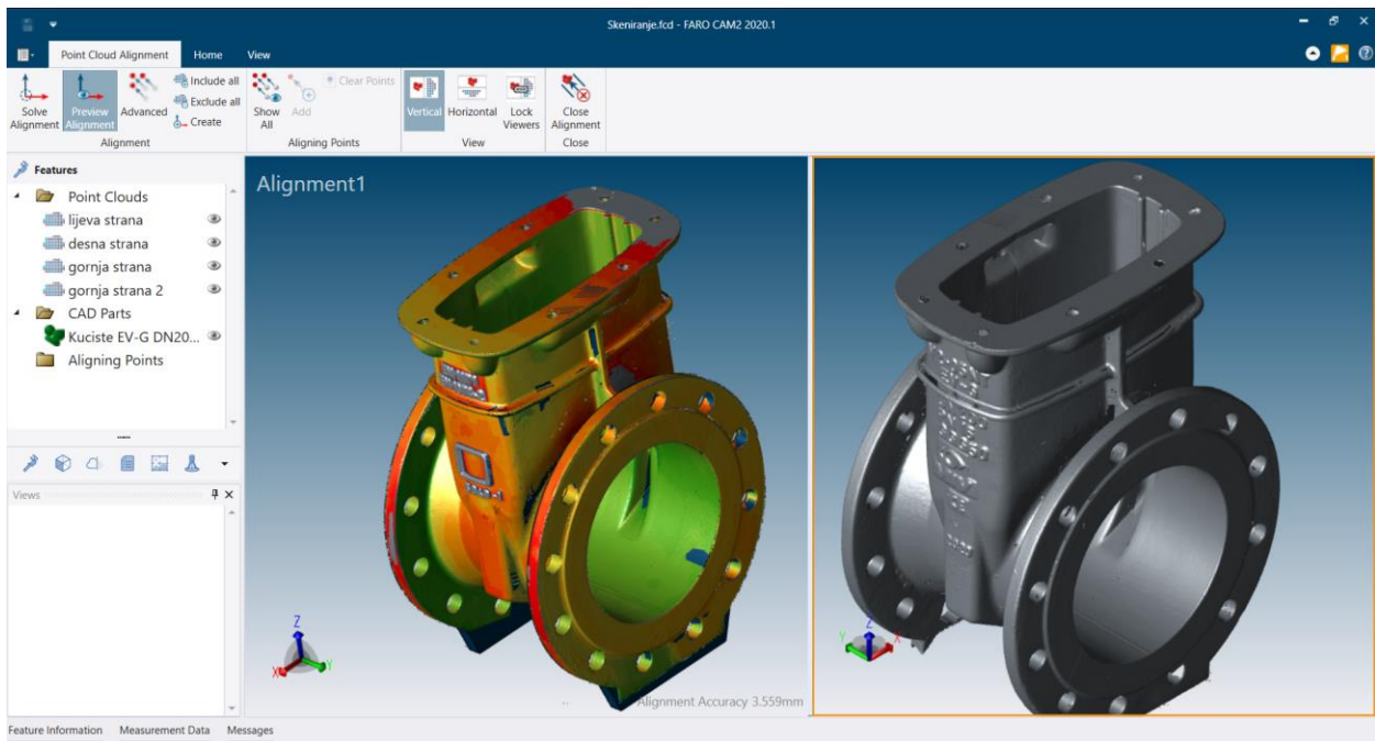
Slika 5.6. Rezultat mjerenja dobiven pomoću 3D laserskog skenera
