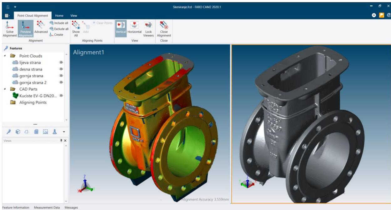
Slika 5.6. Rezultat mjerjenja dobiven pomoću 3D laserskog skenera
