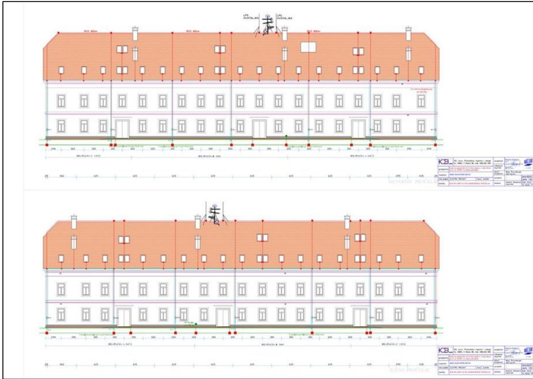
Slika 8.3. Projekt sjevernog pročelja kasarne
