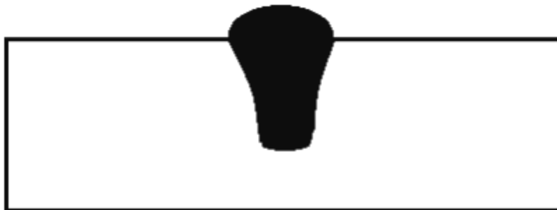
Slika 6.3 Utjecaj ugljikovog dioksida na geometriju zavara
