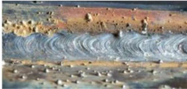
Slika 8.2 Realni izgled prskanja
