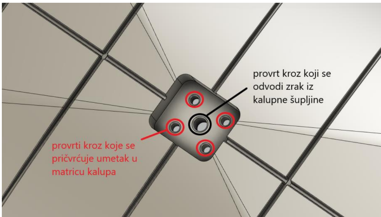
Slika 6.8.2.1. Utor za umetak u matrici kalupa [32]
