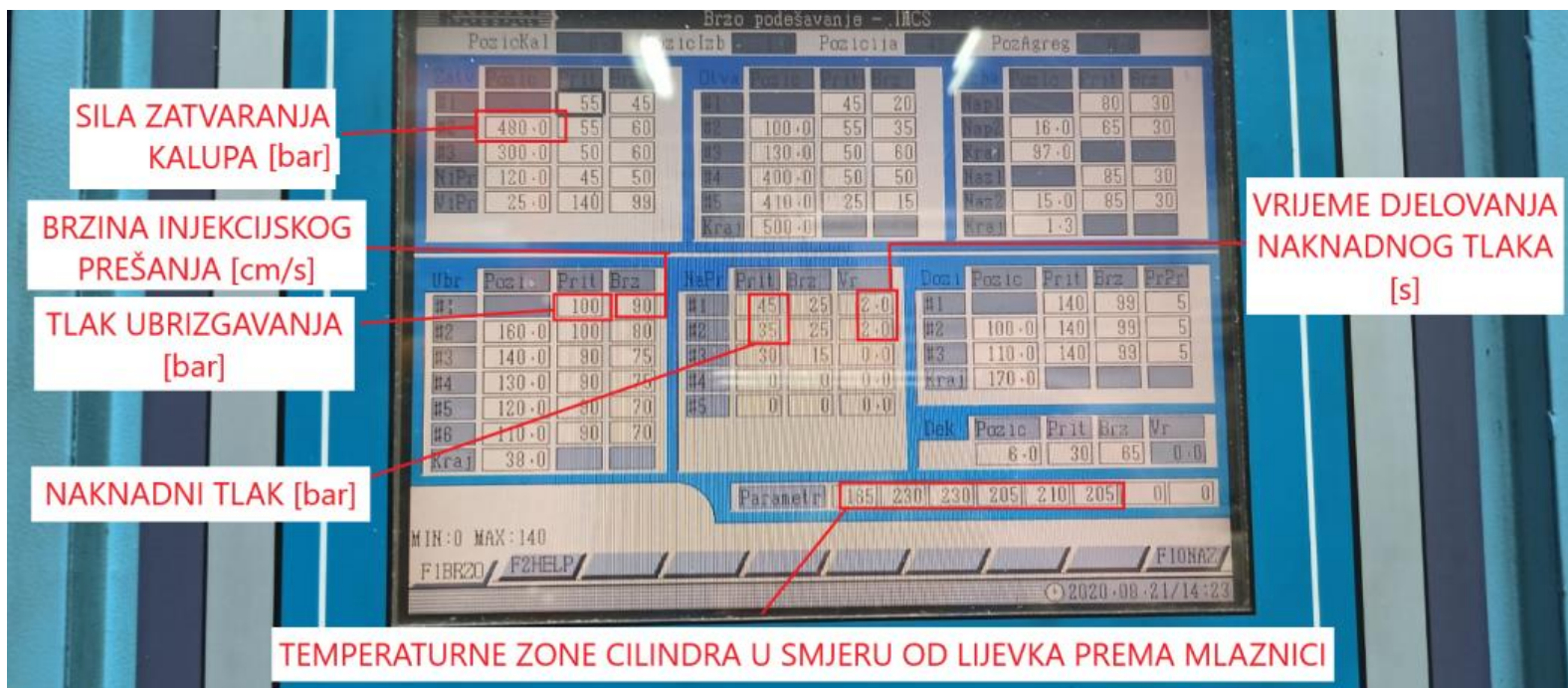
Slika 6.5.1.1. Parametri korišteni kod izrade probnog uzorka [22]
