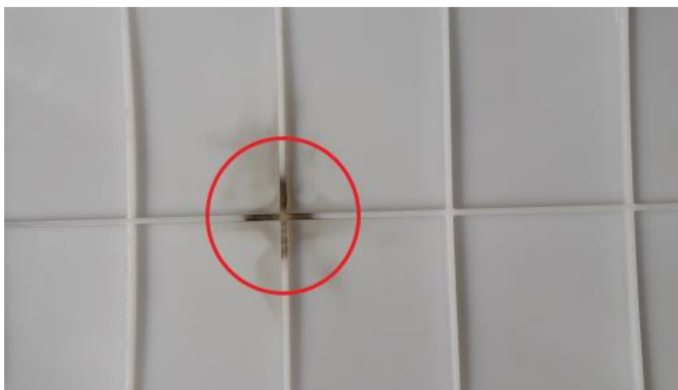
Slika 6.5.2.2. Oštećenje na strani matrice kalupa [24]
