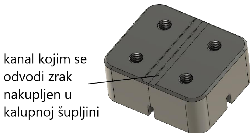
Slika 6.8.2.2. Sklop za ugradnju u utor na matrici [33]
