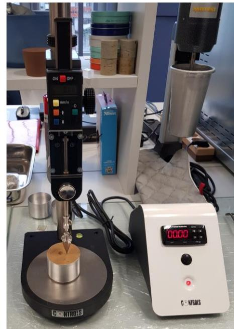
*Slika 4.4. Proces ispitivanja konusnim penetrometrom*
