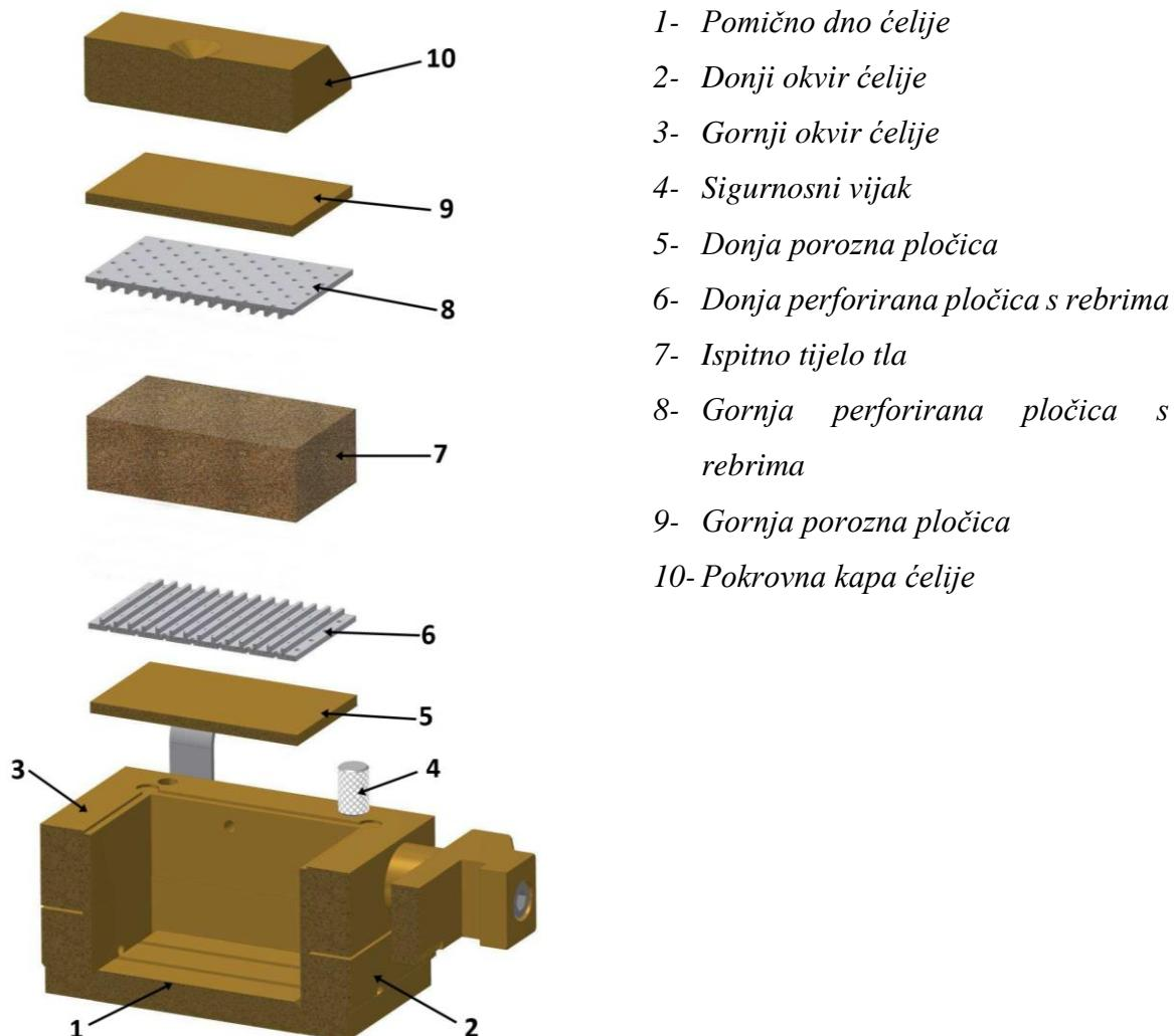
*Slika 4.20. Prikaz dijelova čelije i ugradnje ispitnog tijela u čeliju (izvor [18])*
