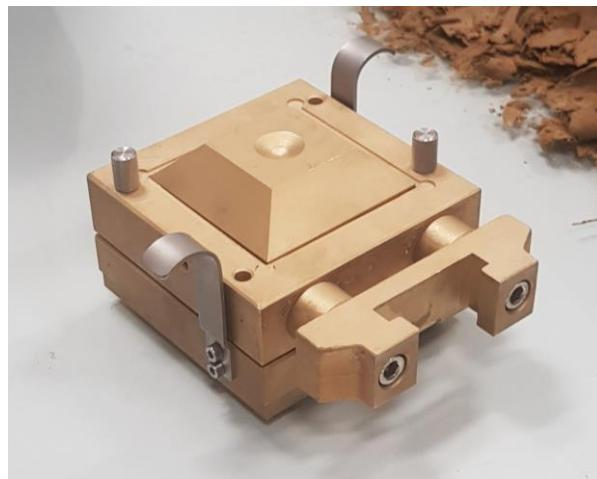
*Slika 4.23. Potpuno sastavljena čelija s ugrađenim ispitnim tijelom*
