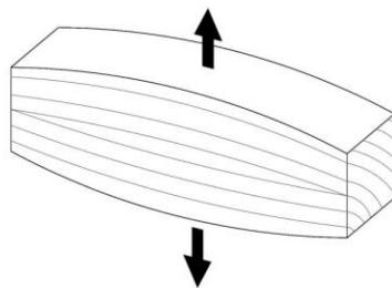
Slika 2.2. Vlačna čvrstoća drva okomito na vlakanca =**2,0 MPa** [20]
