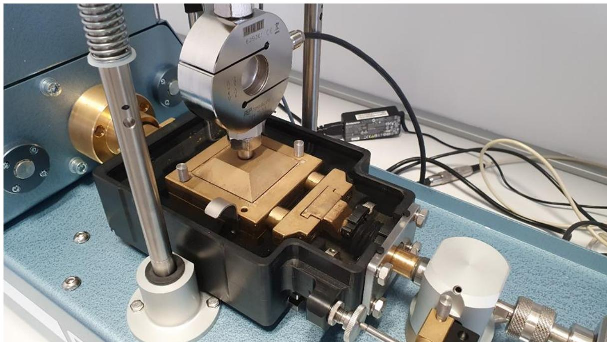
*Slika 4.24. Čelija s ispitnim tijelom ugrađena u vanjsku kutiju za posmik, postavljenu u mehaničke i mjerne sklopove uređaja za ispitivanje*
