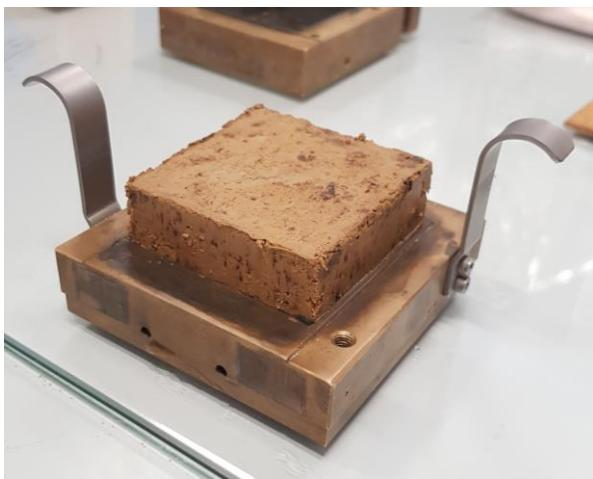
*Slika 4.22. Ispitno tijelo ugrađeno u donji okvir čelije*
