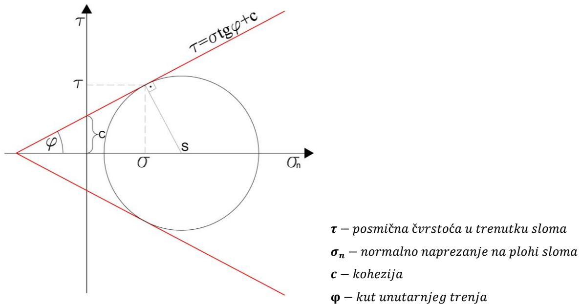
Slika 4.9. Mohr-Coulombov kriterij posmične čvrstoće
