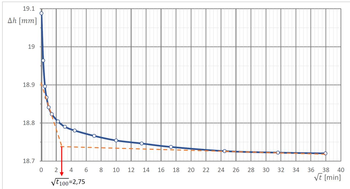
Slika 4.27. Taylorova konsolidacijska krivulja za određivanje vremena  $t_{100}$
