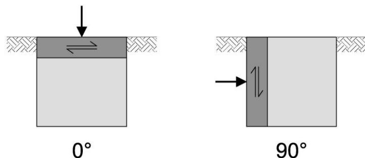
*Slika 4.13. Smjer uzimanja uzorka i smicanja*
