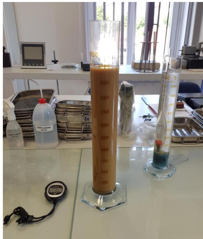
Slika 4.7. Provodenje pokusa areometriranja
