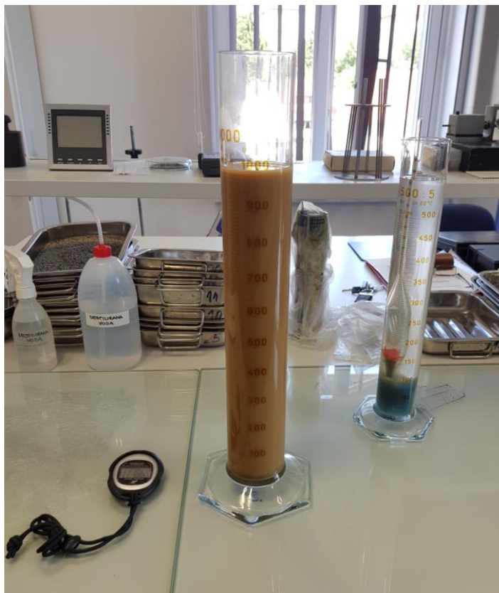
Slika 4.7. Provođenje pokusa areometriranja
