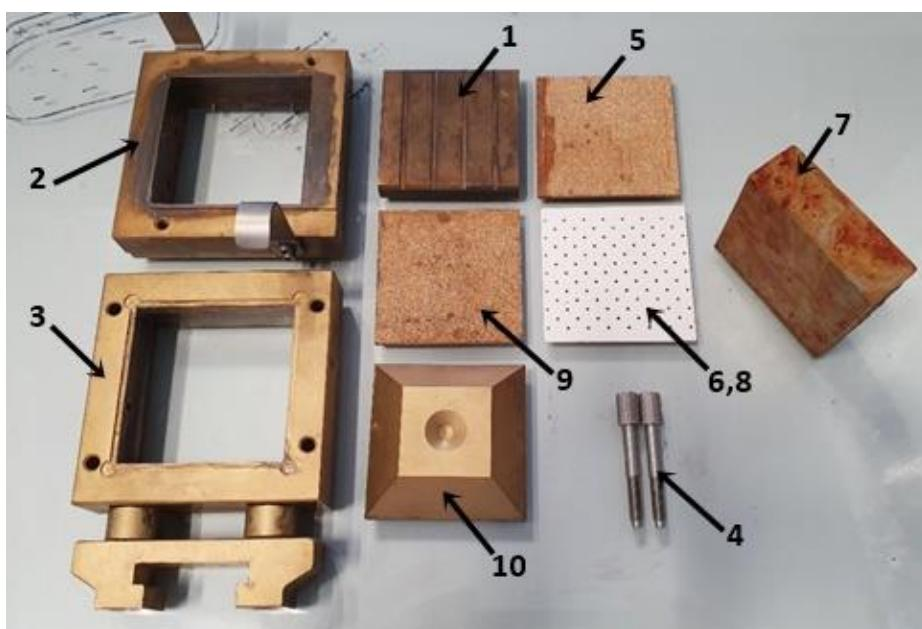
*Slika 4.21. Rastavljena čelija uređaja za izravni posmik (legenda na prethodnoj slici)*
