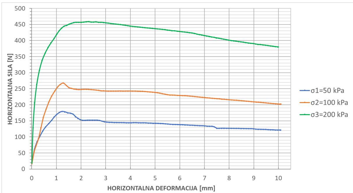
Slika 4.30. Dijagram tijeka posmika za ispitivanje serije 1 pod  $90^\circ$  (3 ispitna tijela)
