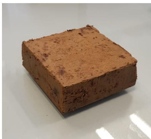
Slika 4.19. Potpuno oblikovano ispitno tijelo istisnuto iz kalupa
