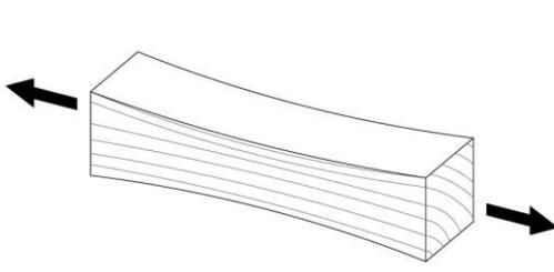
Slika 2.1. Vlačna čvrstoća drva paralelno s vlakancima =**87,6 MPa** [20]
