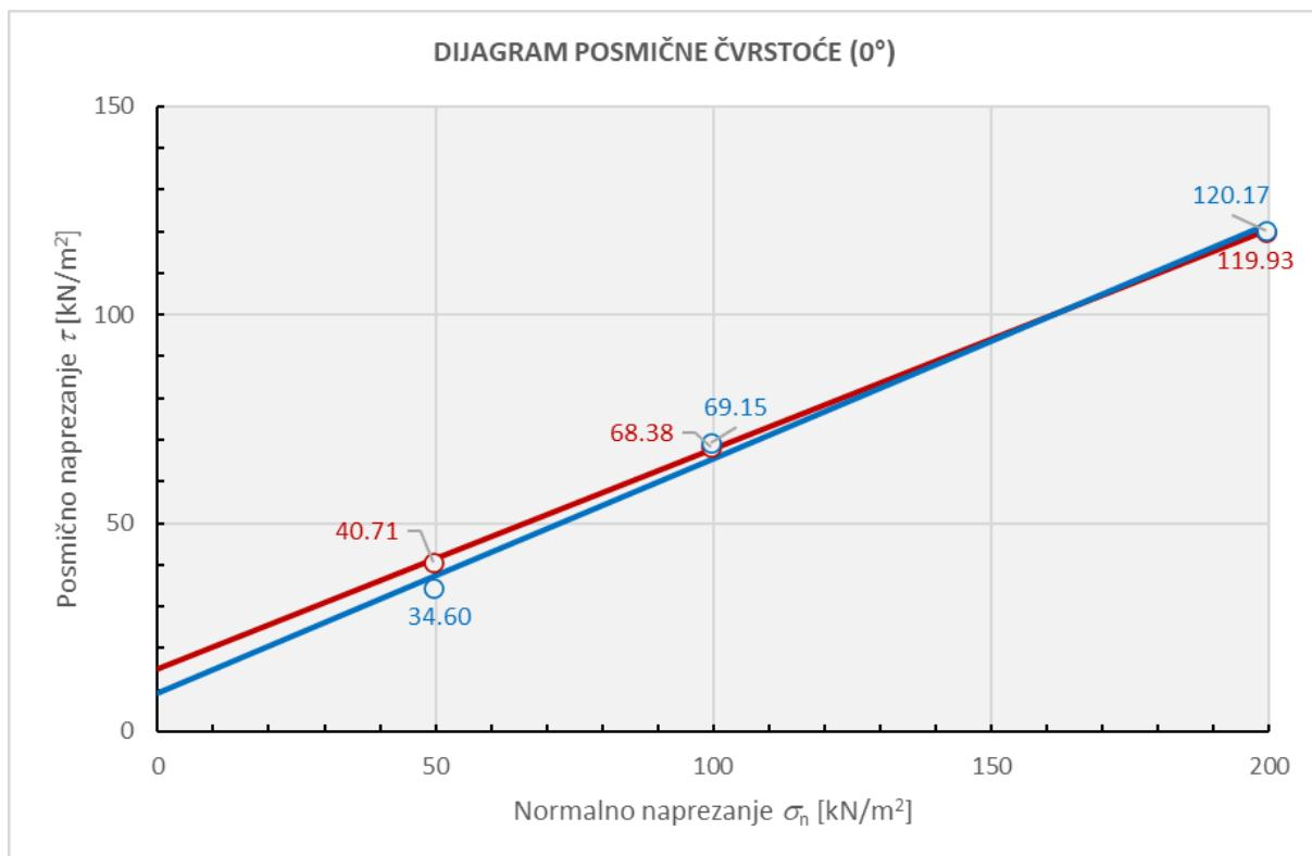
**Slika 4.32.** Dijagram posmične čvrstoće smjer ispitivanja pod  $0^\circ$
