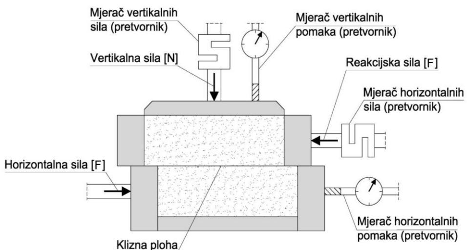
Slika 4.10. Shematski prikaz uređaja za izravan posmik
