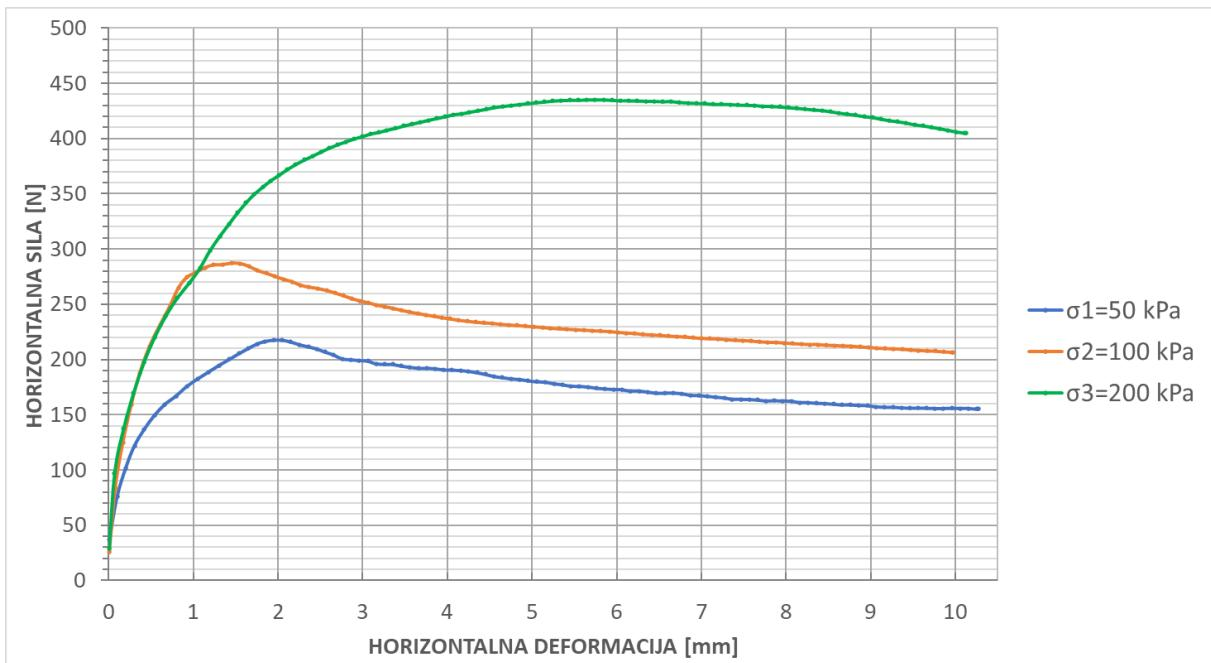
Slika 4.31. Dijagram tijeka posmika za ispitivanje serije 2 pod  $90^\circ$  (3 ispitna tijela)
