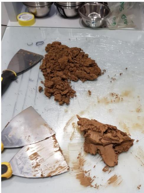
*Slika 4.3. Proces homogeniziranja uzorka*
