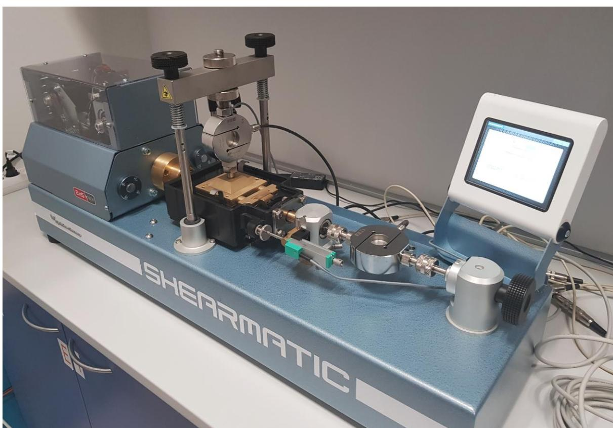
Slika 4.26. Konfiguracija uređaja za izravni posmik s ugrađenim ispitnim tijelom za ispitivanje posmične čvrstoće neposredno prije pokretanja pokusa (vrlo je bitno, ukoliko želimo da uređaj automatski započne smicanje nakon konsolidacije, ukloniti sigurnosne vijke)
