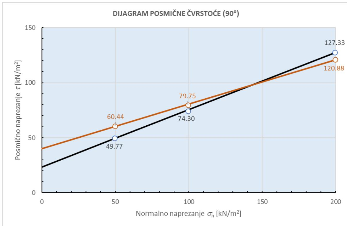
**Slika 4.33.** Dijagram posmične čvrstoće smjer ispitivanja pod  $90^\circ$
