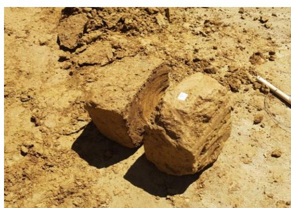
*Slika 3.6. Izvadeni uzorak prepolovljen na dva ispitna uzorka*
