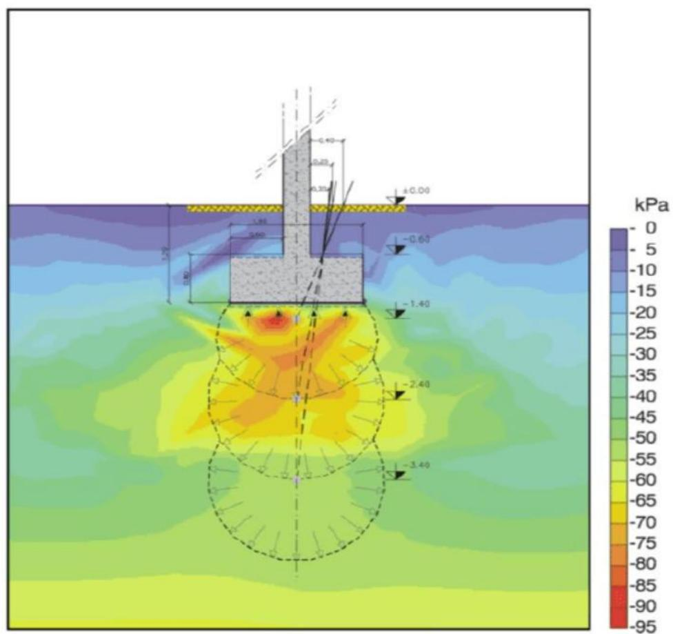
Slika 6.4. - Ojačavanja temeljnog tlu injektiranjem, grafički prikaz
