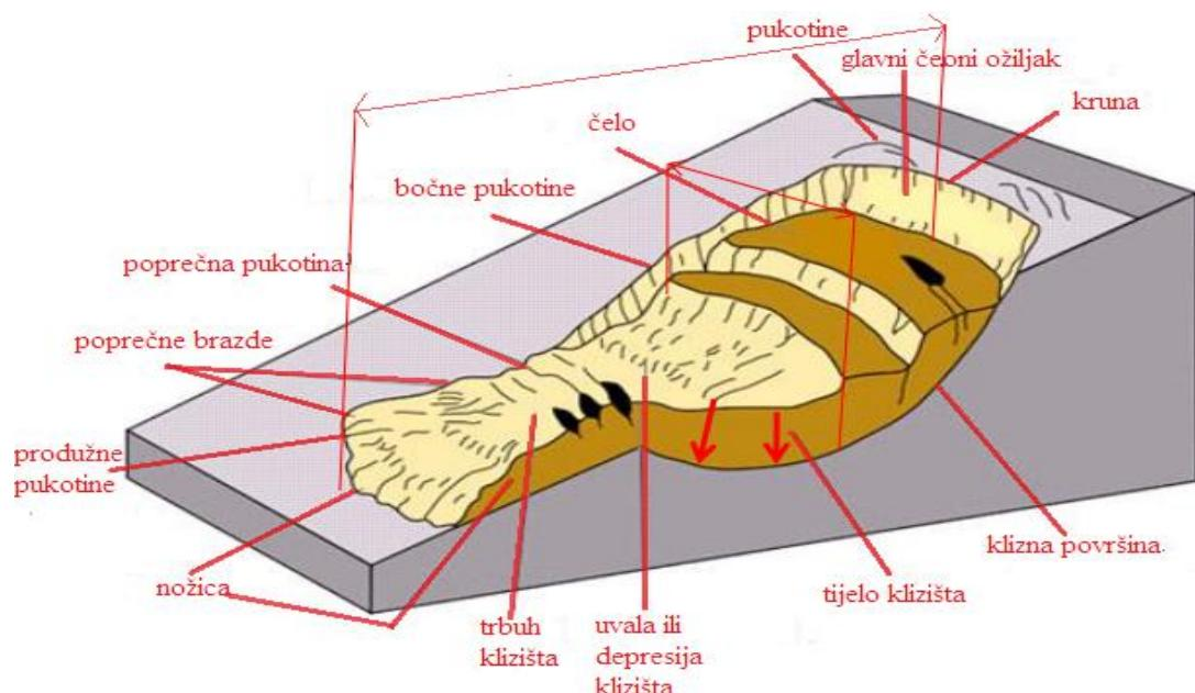
Slika 3.4. - Dijelovi klizišta
