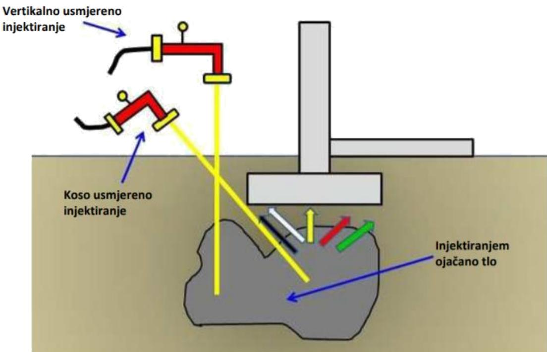
Slika 6.2. - Ojačanje temeljnog tla uz primjenu kemijskog injektiranja
