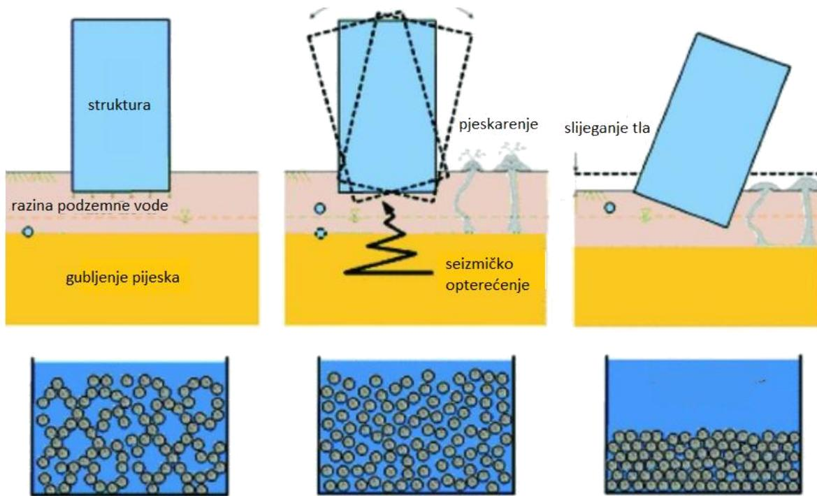
Slika 6.1. - Diferencijalno slijeganja konstrukcije uslijed likvefakcije temeljnog tla
