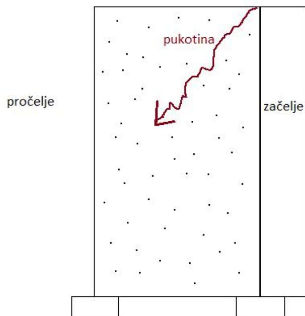
Slika 4.6. - Shematski prikaz širenja jednosmjerne pukotine
