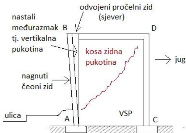
Slika 4.5. - Asimetrična otpornost
