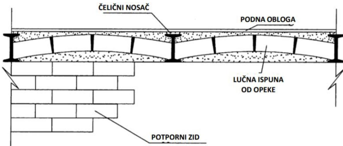
*Slika 5.54. - Shema mogućeg nosivog stropnog sustava podrumske ploče*
