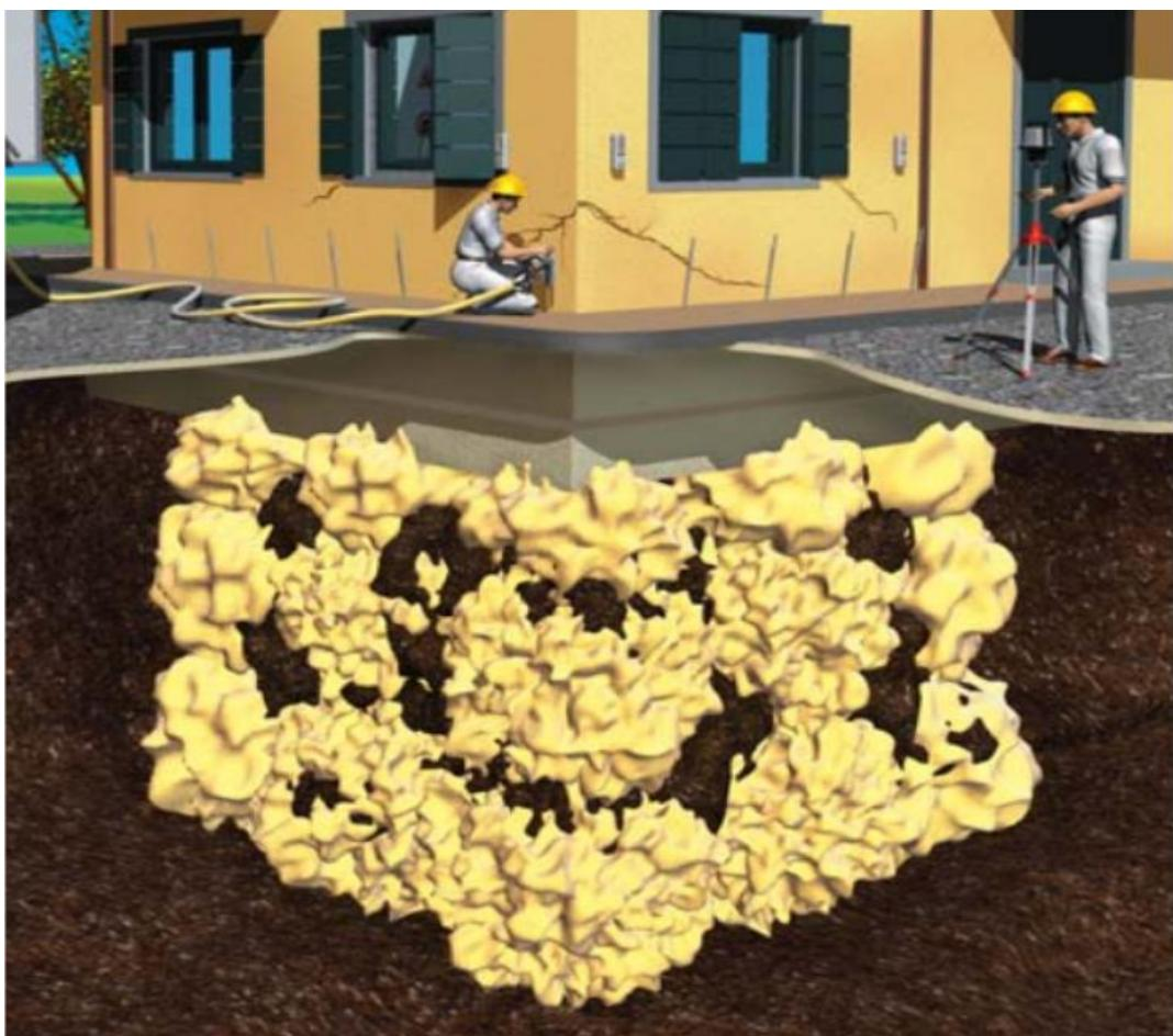
Slika 6.3. - Ojačanje temeljnog tla uz primjenu kemijskog injektiranja s površine
