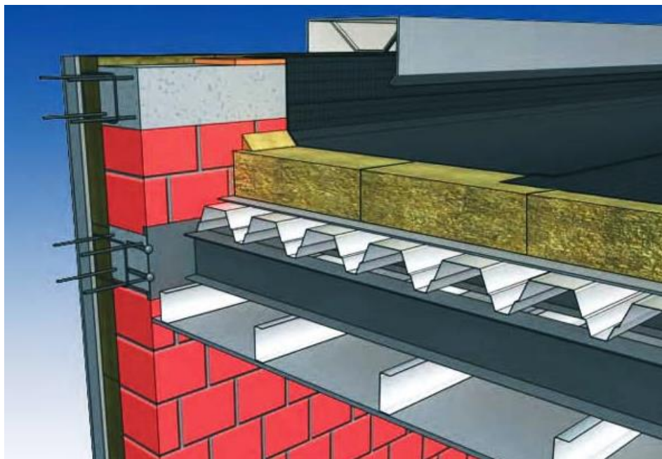
Slika 13. Slojevi neprohodnog ravnog krova
