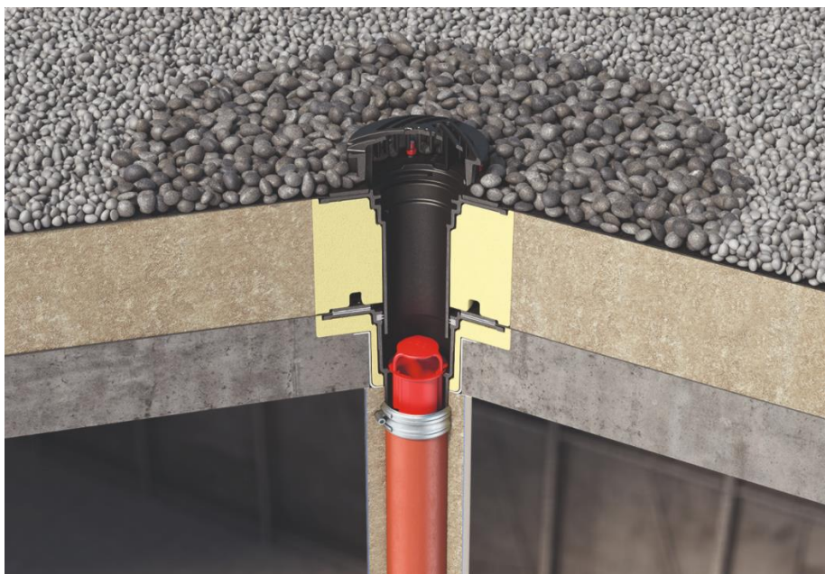
Slika 28. Primjer ugradnje slivnika na ravnom krovu
