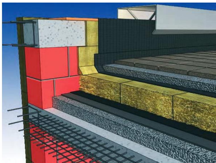
Slika 9. Izolacija ravnog prohodnog krova
