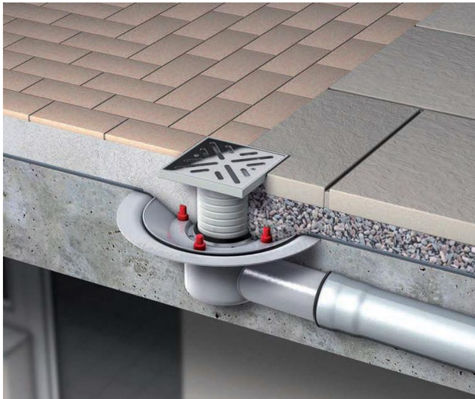
Slika 31. Slivnik za terase i balkone
