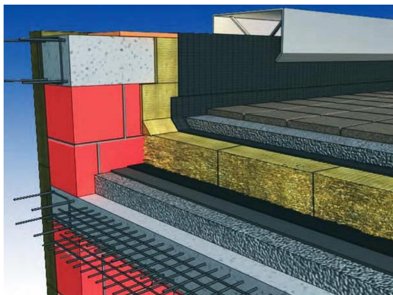
Slika 9. Izolacija ravnog prohodnog krova
