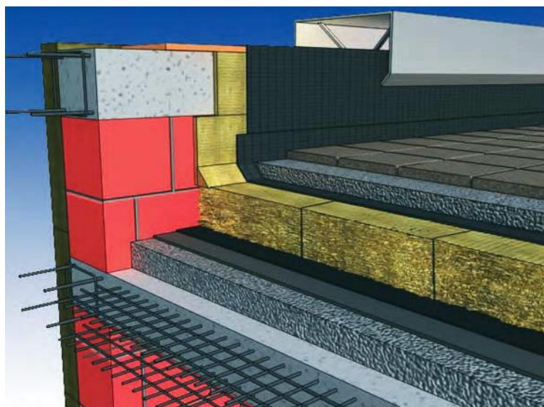
Slika 9. Izolacija ravnog prohodnog krova
