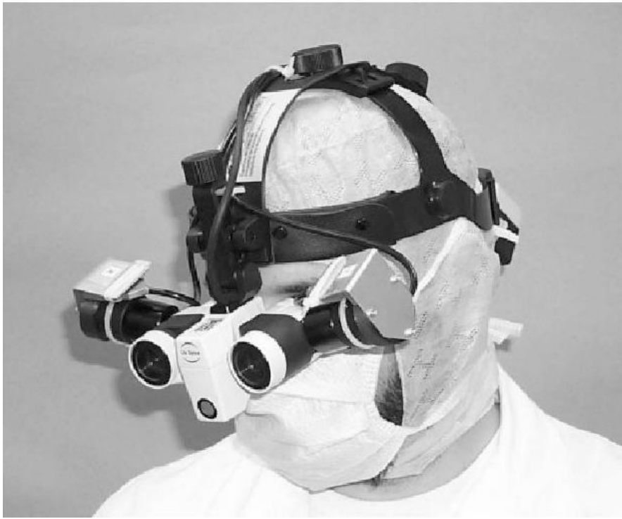
Slika 12 Prototip Varioscope AR sa dva minijturna VGA zaslona postavljena okomito na glavne leće
