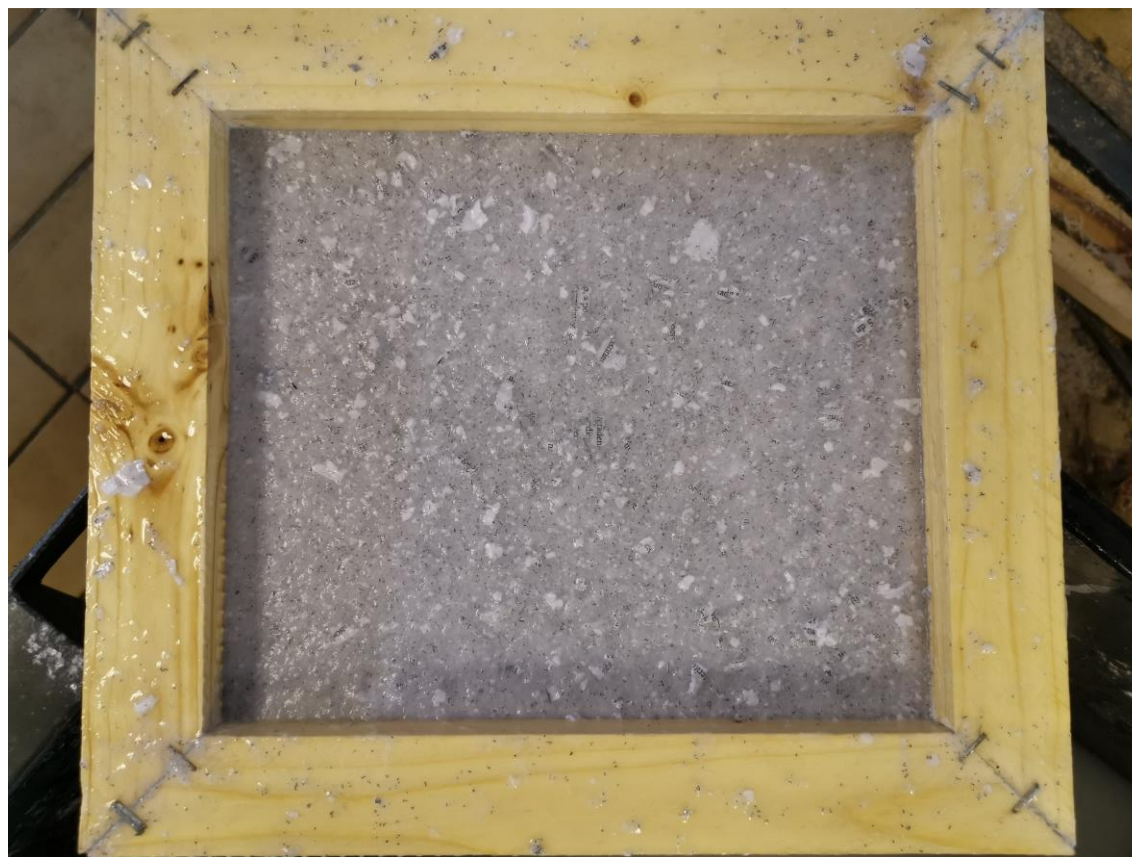
Slika 22 Cijeđenje viška vode sa kalupa
