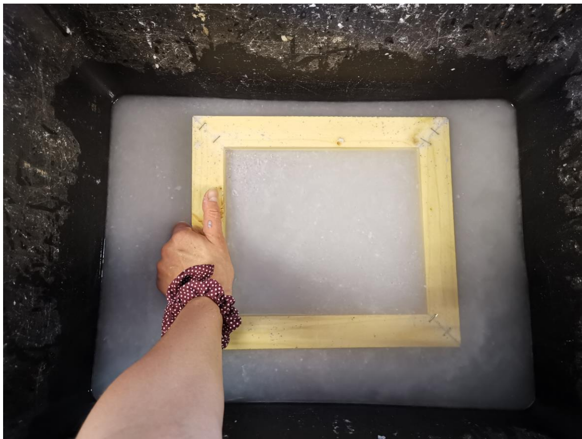
Slika 21 Umakanje kalupa u vodu
