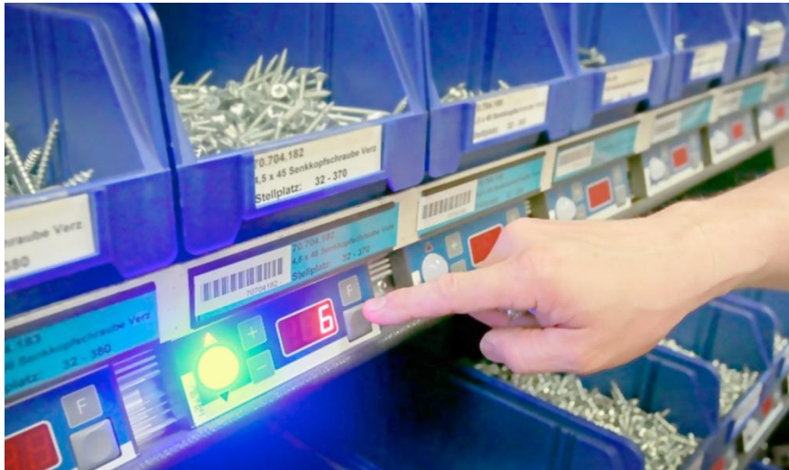
Slika 8. Pick To Light uređaj u skladištu , izvor: https://www.kbs-gmbh.de/en/classiv-pick-by-light-module-for-shelving-systems/ (pristupljeno 29. kolovoza 2020.)
