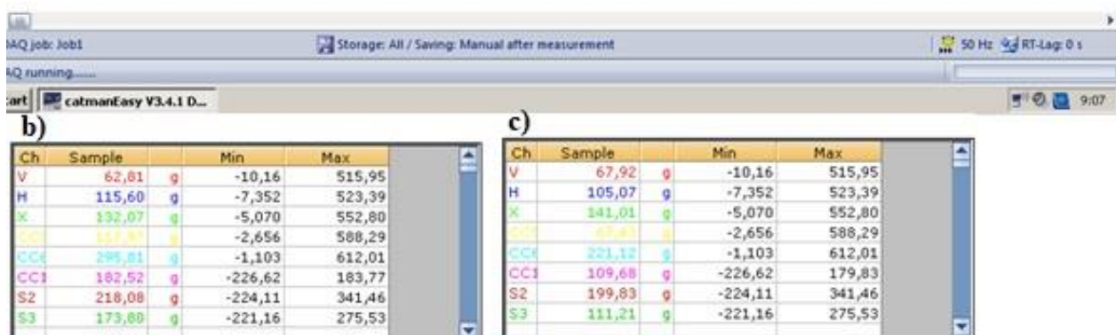
Slika 3.23: Mjerenje bočnog tlaka pod kutom 0^\circ u softveru "Catman © Easy"; a) Prikaz dijagrama i izmjerenih vrijednosti prvog mjerenja; b) prikaz izmjerenih vrijednosti drugog mjerenja; c) prikaz izmjerenih vrijednosti trećeg mjerenja
