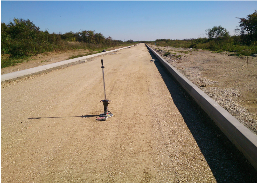
Slika 5.1 Ispitivanje modula stišljivosti kružnom pločom (vlastiti izvor)
