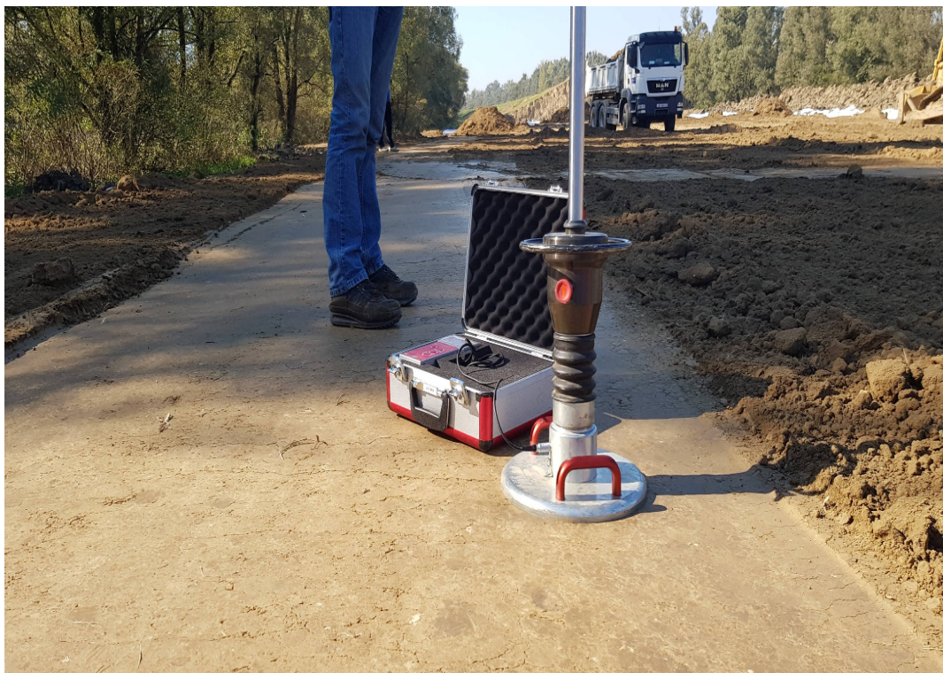
Slika 4.6 Ispitivanje posteljice kružnom pločom (vlastiti izvor)
