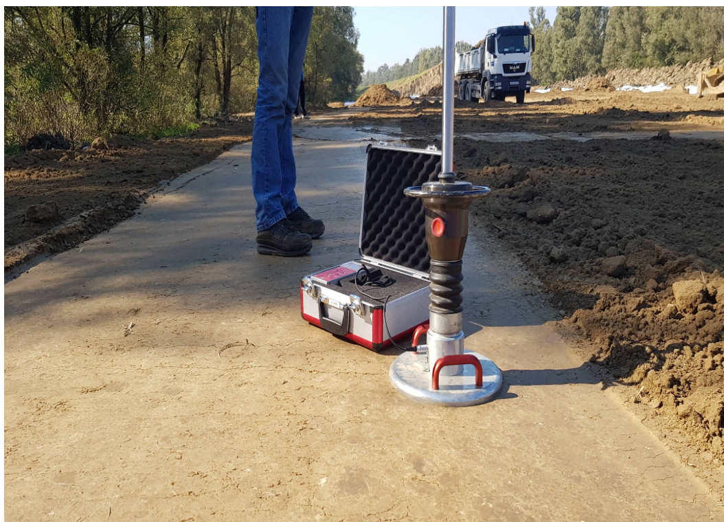
Slika 4.6 Ispitivanje posteljice kružnom pločom (vlastiti izvor)
