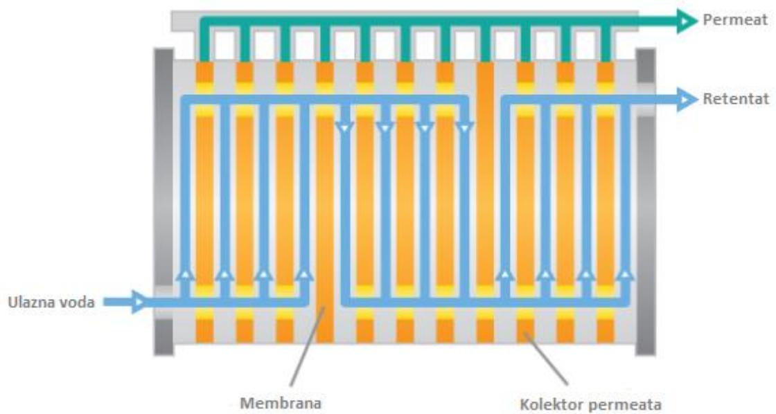
*Slika 3.1. Membranski modul na principu filter preše [5]*
