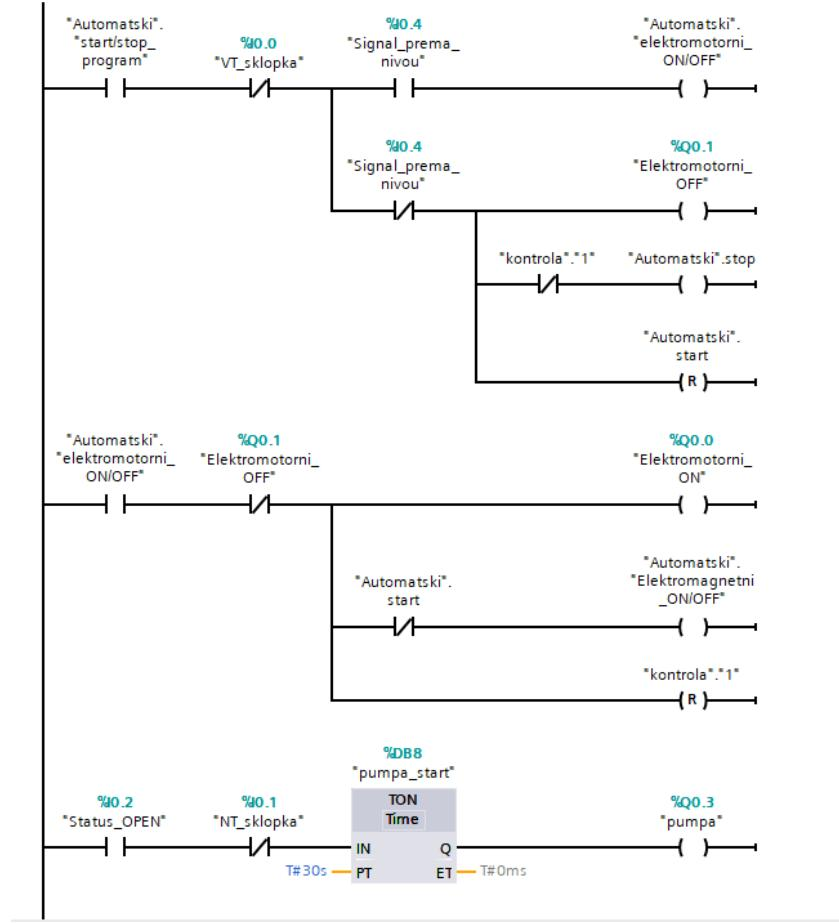
Slika 4.3. Program za upravljanje elektromotornim ventilom i pumpom
