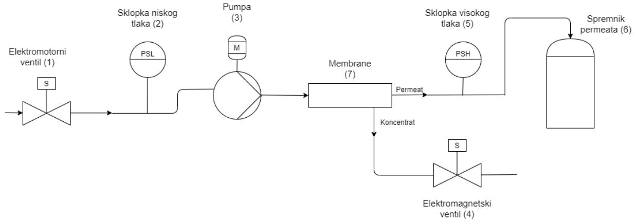
*Slika 2.2. Dijelovi pogona reverzne osmoze*
