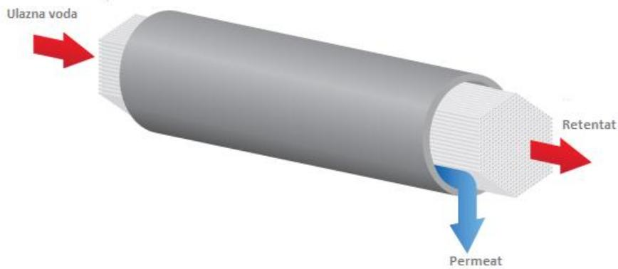
Slika 3.3. Membranski modul sastavljen od šupljih vlakana [7]
