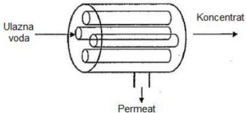
*Slika 3.2. Cijevni modul [6]*
