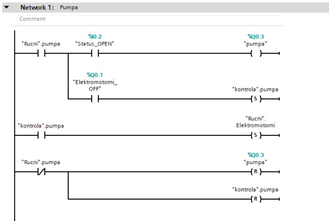
Slika 4.6. Rad pumpe u ručnom načinu rada
