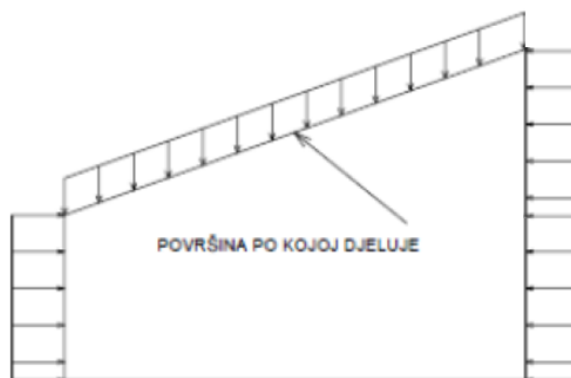
Slika 20 Skica djelovanja Unutarnjeg podtlaka na konstrukciju*
