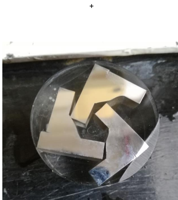
Slika 29. Uzorci nakon poliranja
