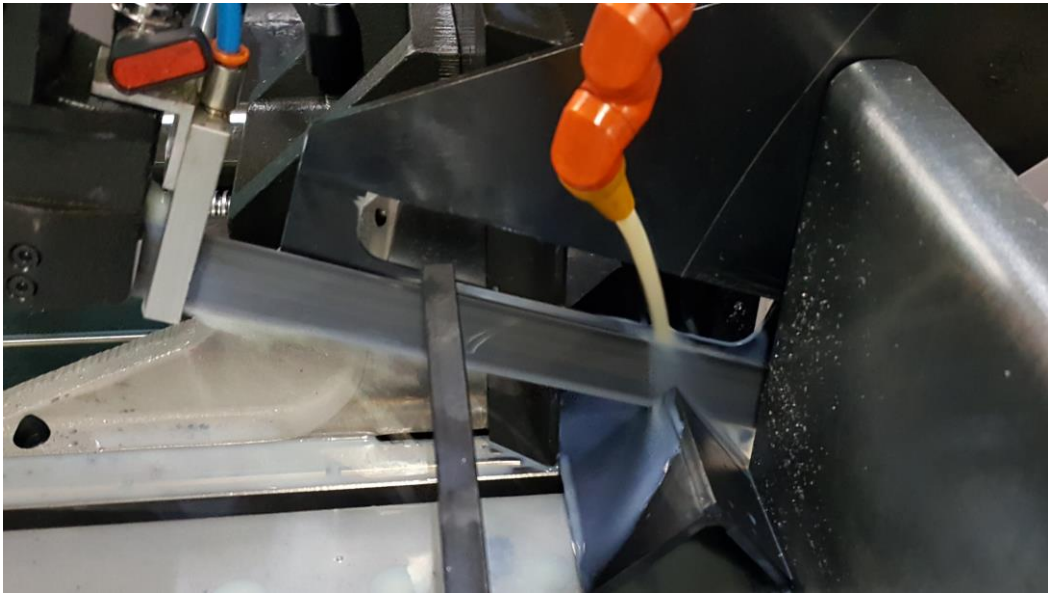
Slika 22. Rezanje zavarenih uzoraka
