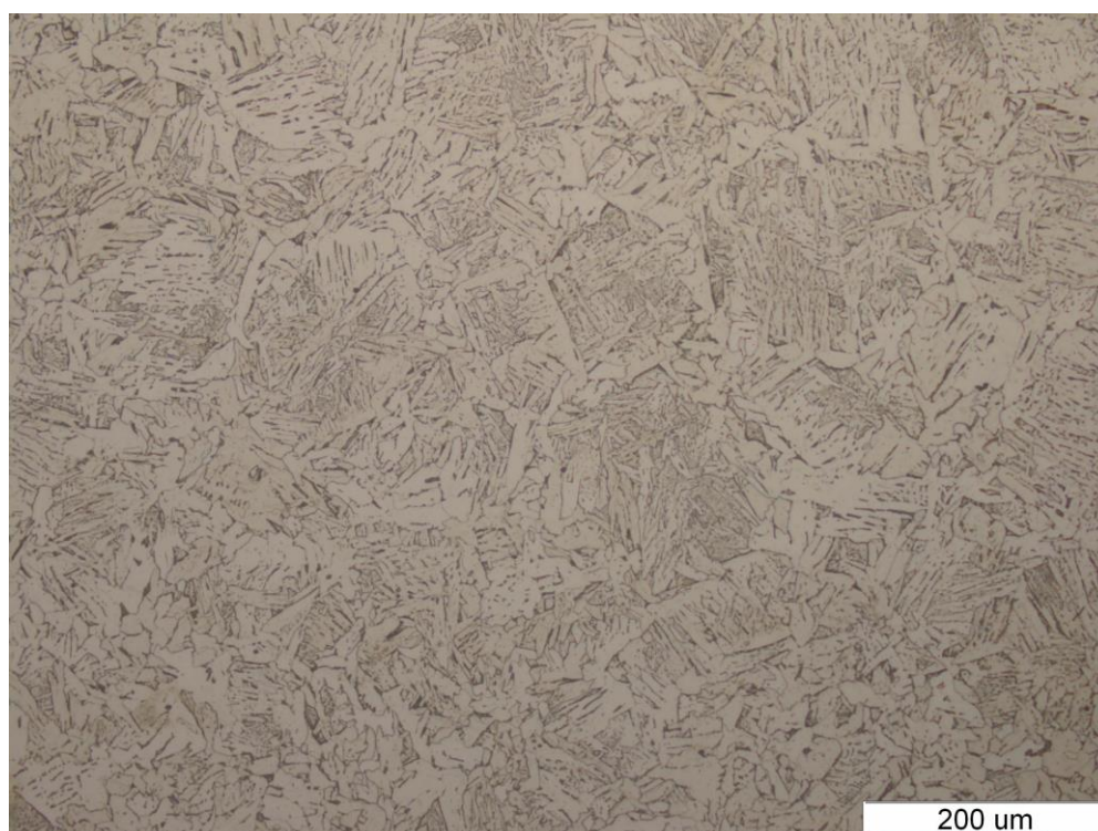
Slika 36. Mikrostruktura zona utjecaja topline pri povećanju 200x - Uzorak 3
