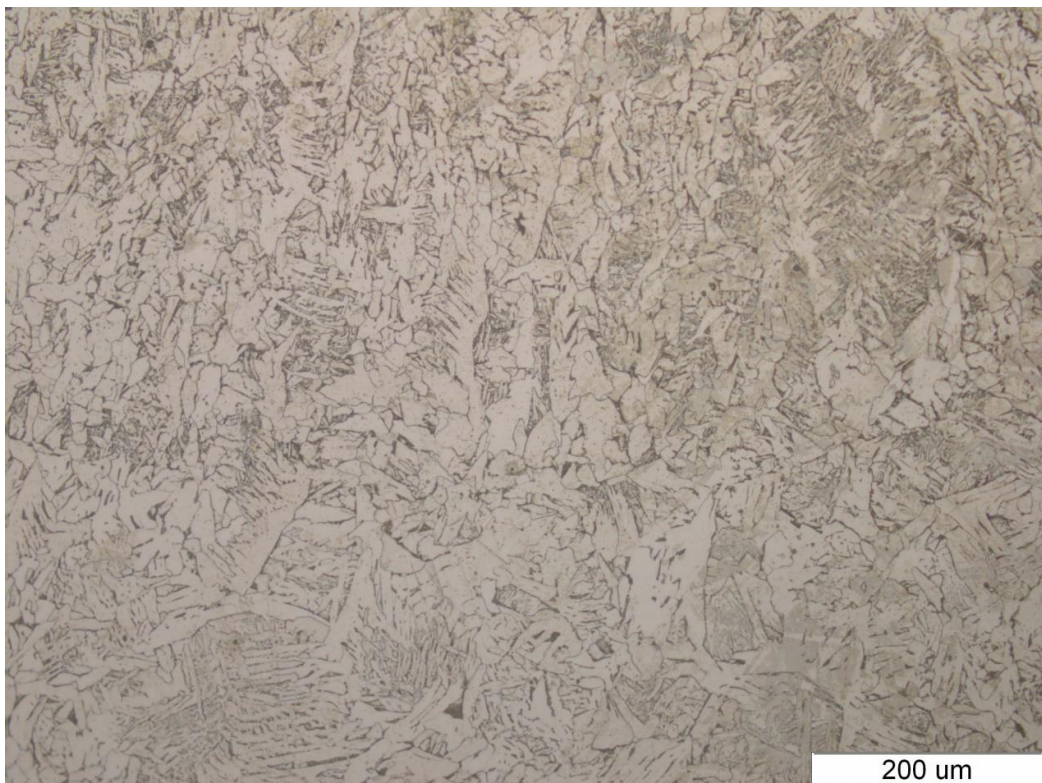
Slika 34 . Mikrostruktura korijena zavora pri povećanju 200 x - Uzorak 2
