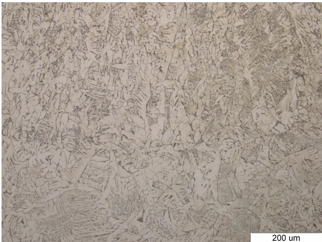
Slika 34 . Mikrostruktura korijena zavora pri povećanju 200 x - Uzorak 2
