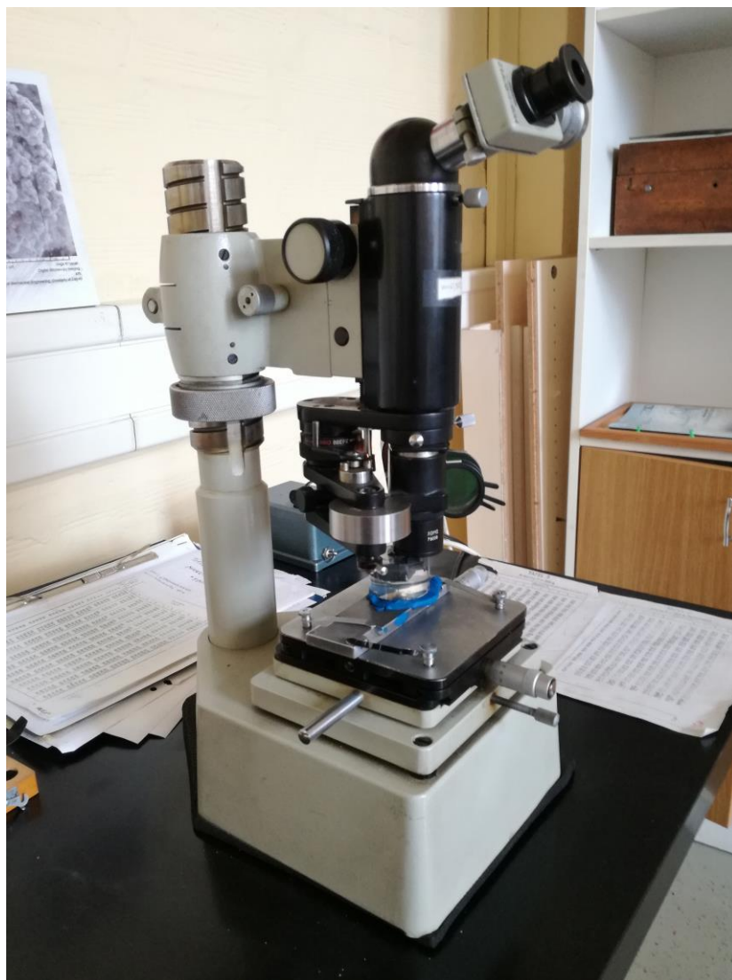
Slika 37. Mjerni uređaj za ispitivanje tvrdoće metodom Vickers
