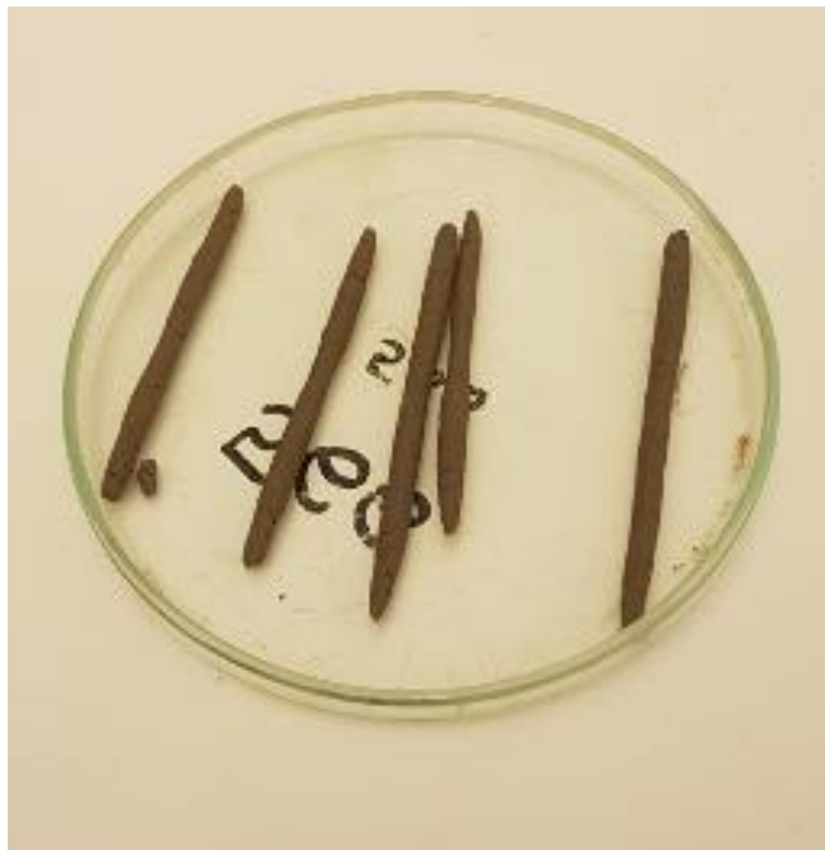
Slika 3.3. Pripremljeni uzorci valjčića kod ispitivanje granica plastičnosti
