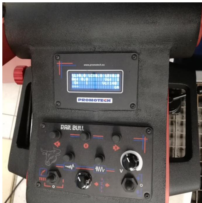
Slika 51. Kontrolna ploča uređaja za automatsko zavarivanje
