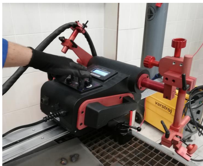
Slika 52. RAIL BULL uređaj za automatizacijsko zavarivanje
