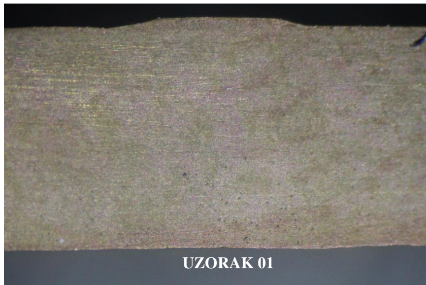
Slika 58. Poprečni presjek zavarenog spoja uzorka 01
