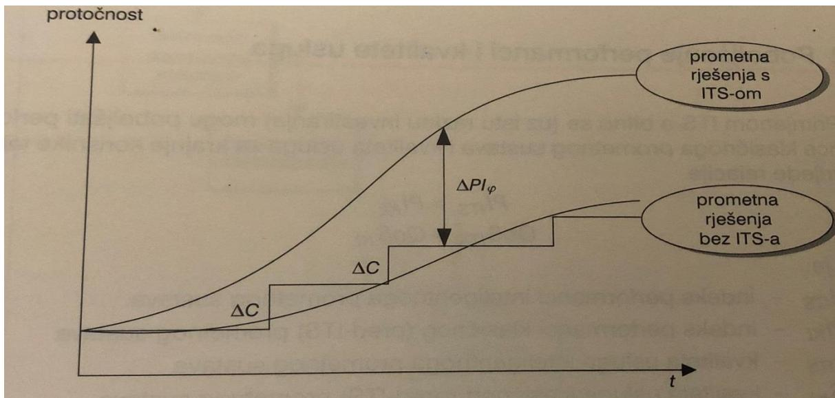
Slika 2. Poboljšanje protočnosti prometnog sustava primjenom ITS-a
