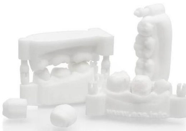
Slika 8. Objekt ispisan SLS tehnologijom (dentalni model) [9]
