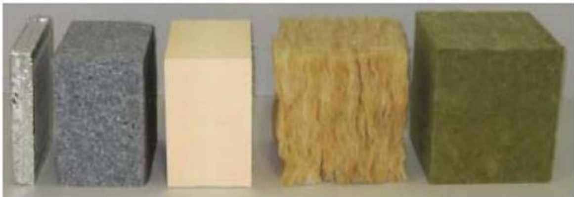
Slika 5.2.2. Debljine (VIP, EPS, XPS, mineralna vuna, kamena vuna) za U = 0.3 \text{ W/ m}^2\text{K}
