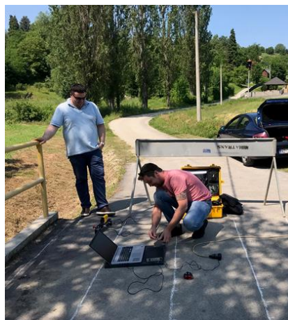
Slika br.4.2. Priprema za ispitivanje metodom Impact-Echa
