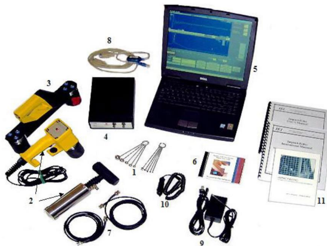
Slika 2.9. Prior za ispitivanje Impact – Echa [6]
