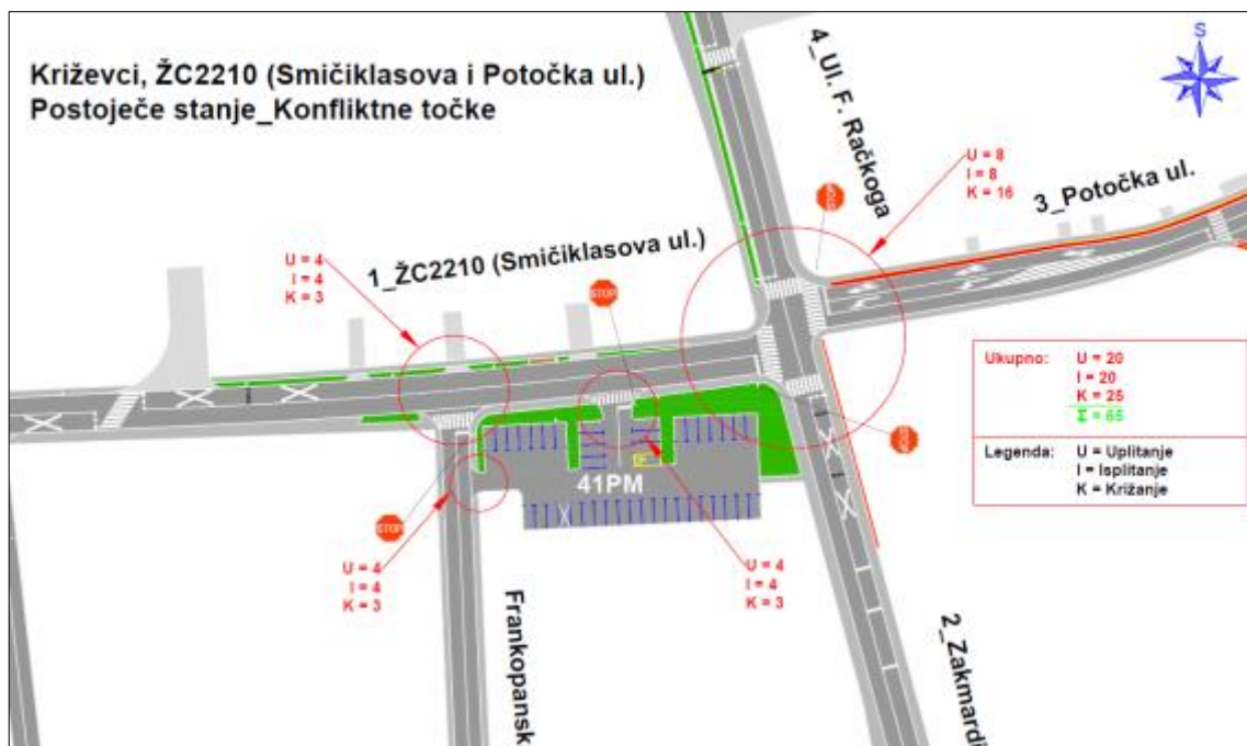
Slika 6. Analiza konfliktnih točaka na raskrižju ŽC2210 (Smičiklasova i Potočka ul.) i nerazvrstane ceste (Ul. F. Račkoga i Zakmardijeva ul.)[1]
