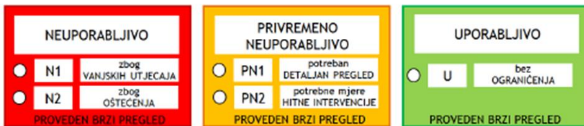
Slika 3.10. Razine oštećenja koje su utvrđivane brzim pregledima
