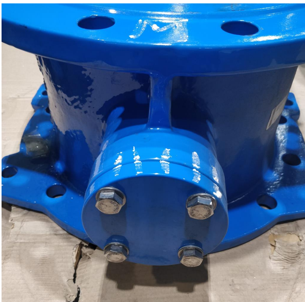
Slika 27. Primjer oznake greške montaže
