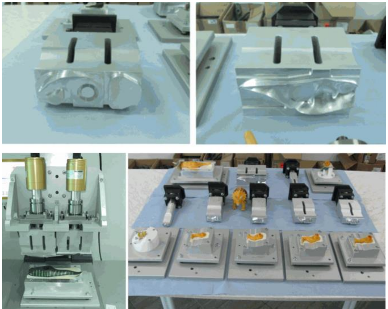
Slika 4.4.2. Sonotrode (alati za zavarivanje) [39]
