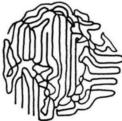
Slika 1.2.6.2. Polukristalni polimer (amorfna i kristalna struktura) [2]
