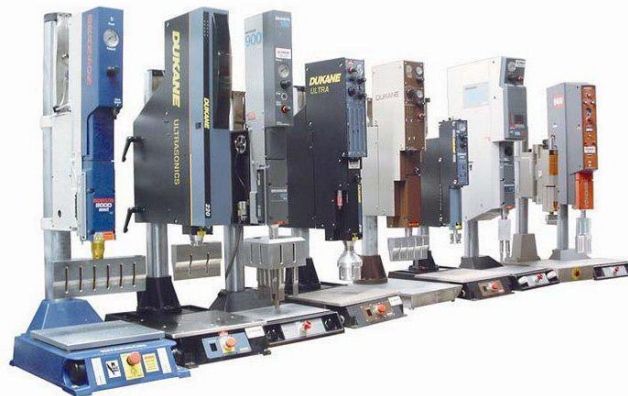
Slika 4.2.3. Strojevi za ultrazvučno zavarivanje [31]
