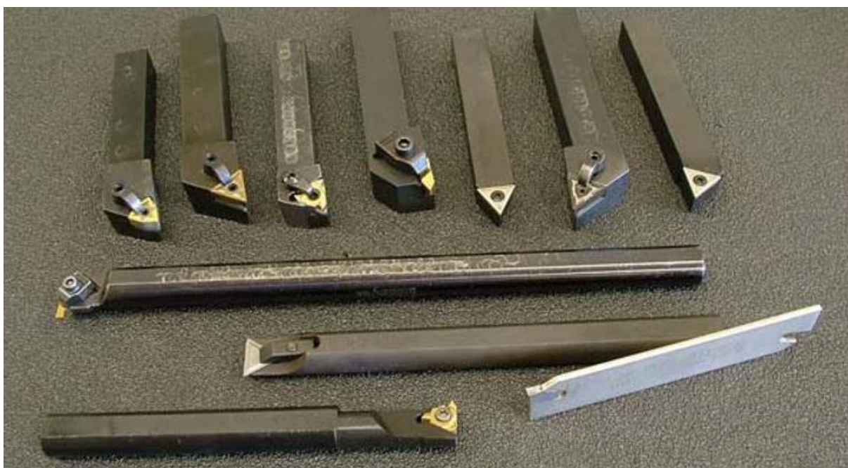
Slika 3.8. Prikaz različitih varijanti tokarskih noževa [10]
