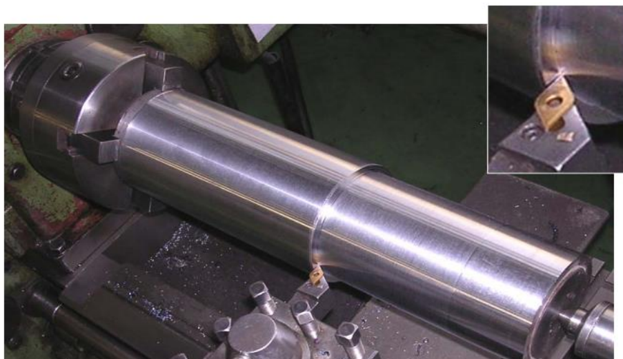
Slika 3.2. Uzdužno vanjsko tokarenje [8]
