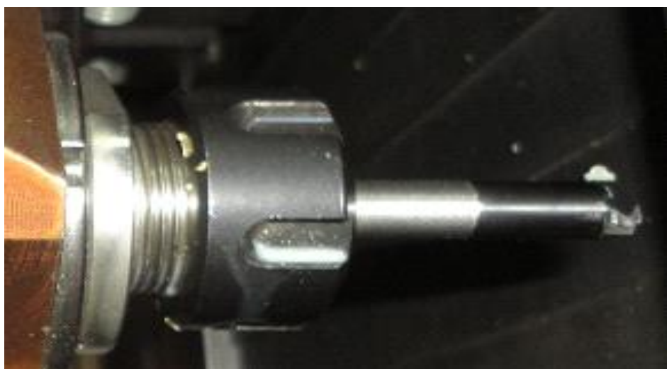
Slika 6.24. Glodalo za izradu navoja u gonjenom prihvatu [15]
