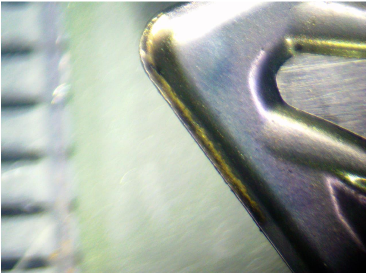
Slika 7.7. Prikaz istrošenosti pločice po duljini rezne oštrice za slučaj I-1. [17]
