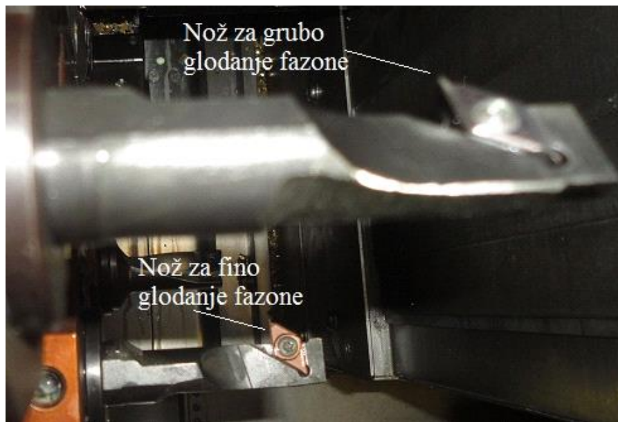
Slika 6.22. Nož za tokarenje s pločicom za fino unutarnje tokarenje fazone [15]
