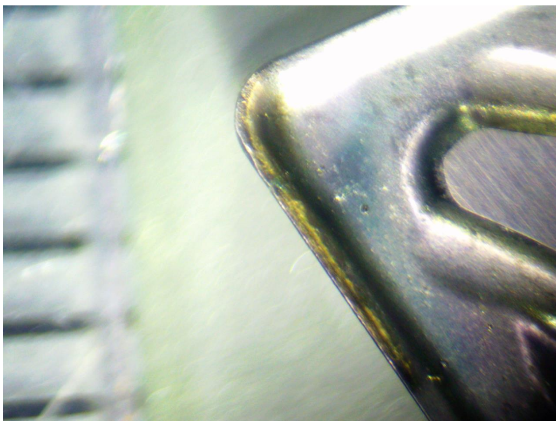
Slika 7.15. Prikaz istrošenosti pločice po duljini rezne oštrice za slučaj II-2. [17]
