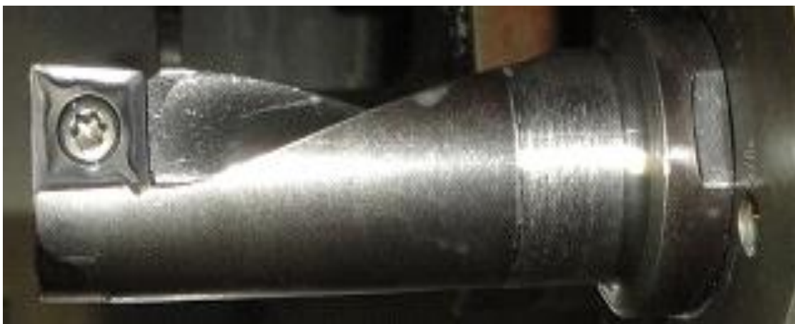
Slika 6.14. Nož za tokarenje sa pločicom za grubo unutarnje tokarenje (ECOCUT)
