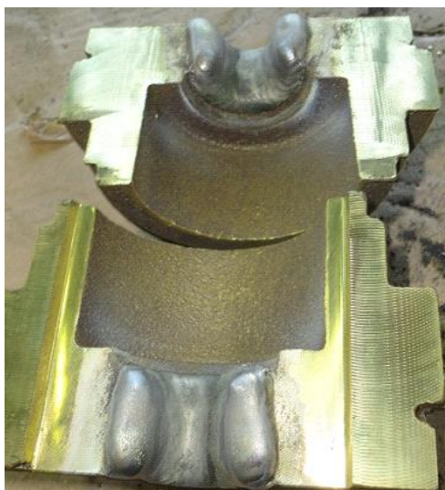
Slika 6.3. Izgled navarenog komada [15]
