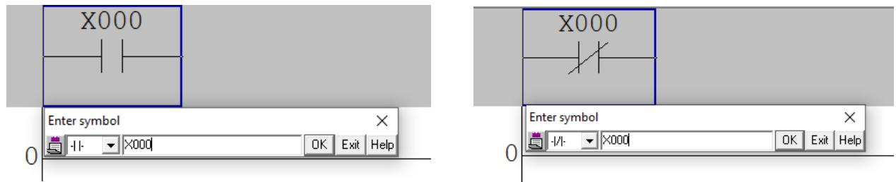
Slika 1.16 Prikaz otvorenog (lijevo) i zatvorenog (desno) kontakta
