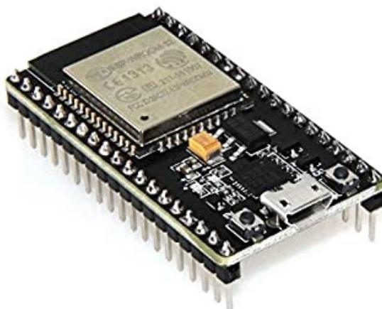
Slika 3.2 Prikaz ESP32 mikrokontrolera [12]
