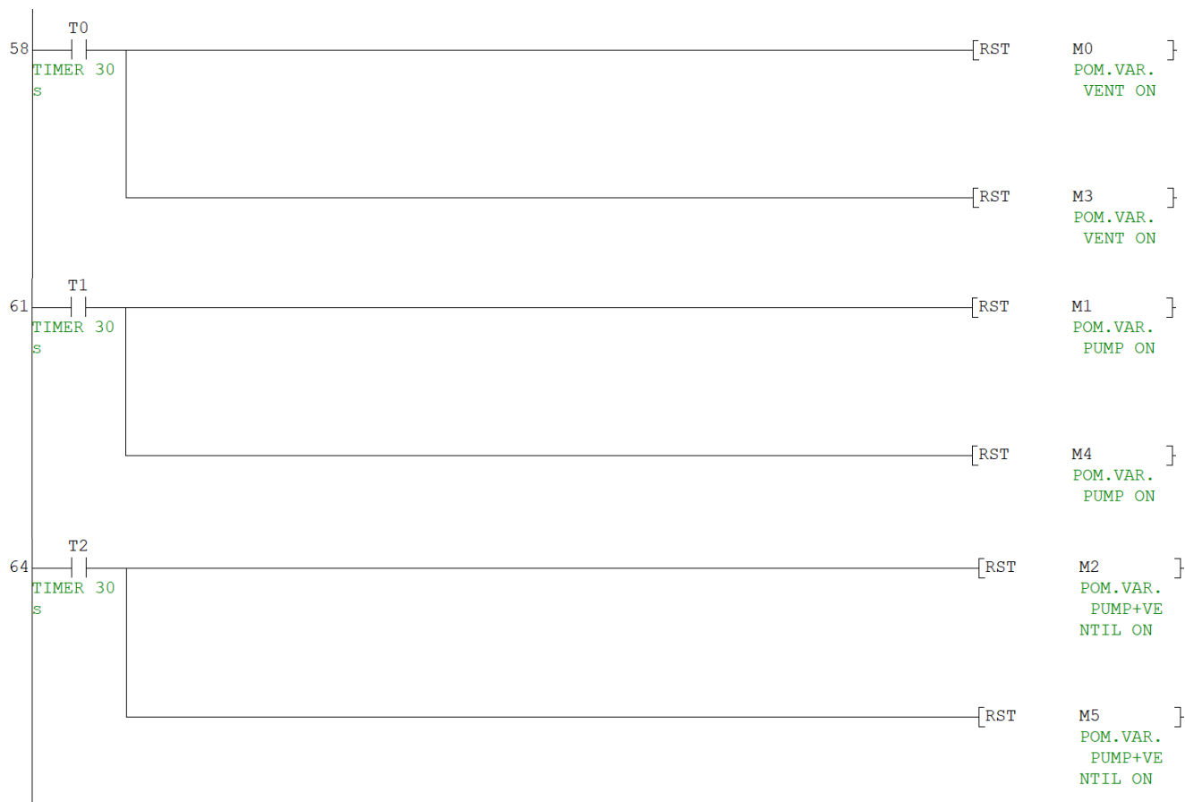
Slika 1.24 Prikaz djela programa za reset pomoćne varijable preko timera
