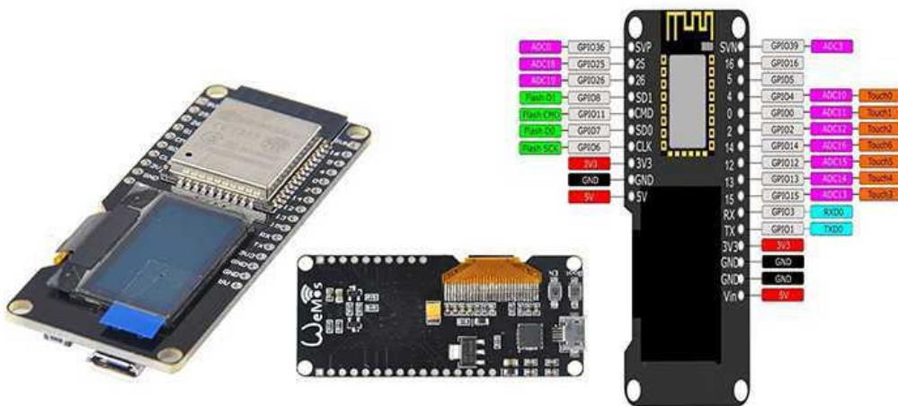
Slika 3.15 Prikaz ESP32 Makerfocus OLED razvojne ploče [30]
