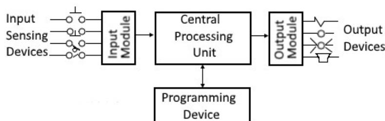
Slika 1.3 Prikaz blok dijagrama PLC uređaja [4]
