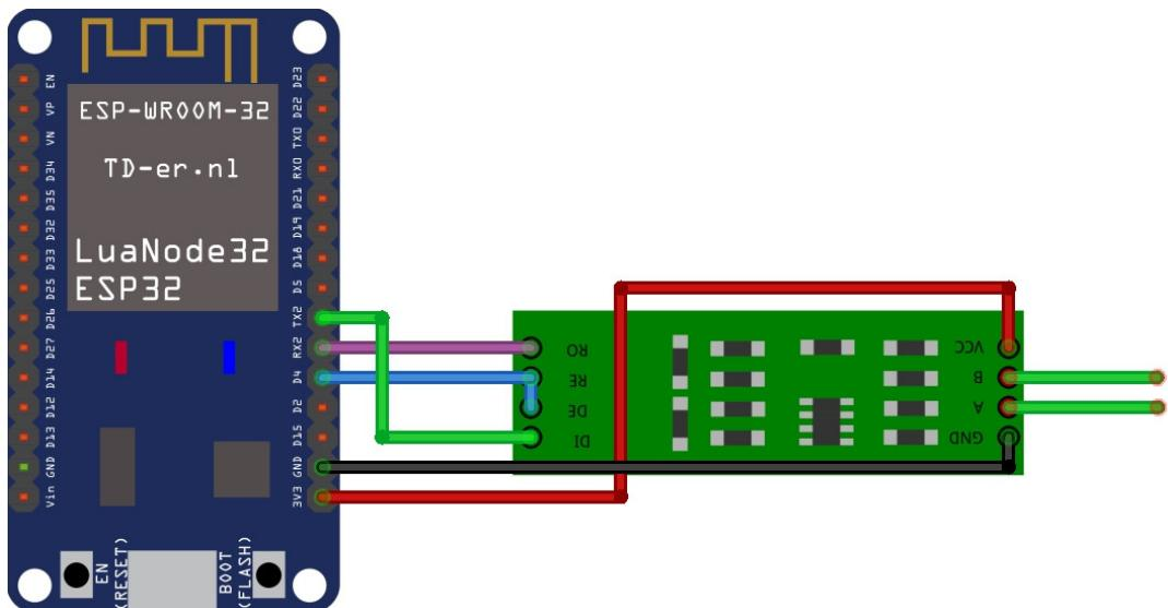
Slika 3.4 Prikaz povezivanja ESP32 mikrokontrolera sa TTL-RS485 [16]
