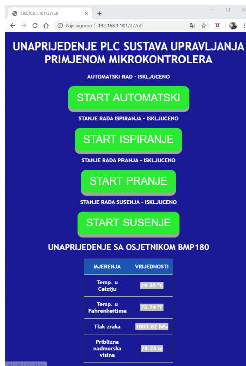
Slika 3.13 Prikaz ažuriranog sučelja unaprijeđenog osjetnikom BMP180
