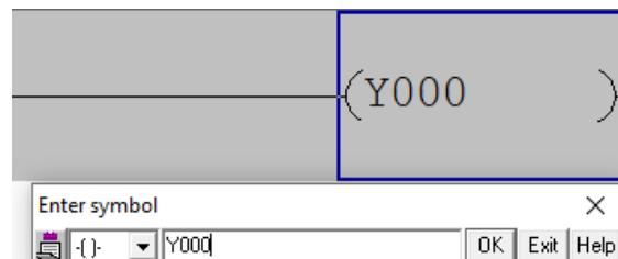
Slika 1.18 Prikaz zavojnice releja – izlaz PLC-a
