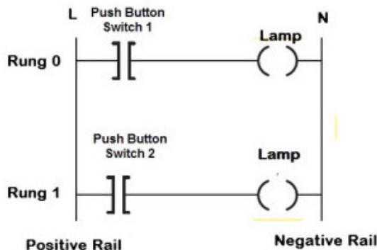
Slika 1.5 Prikaz PLC programiranja Ladder dijagramom [4]
