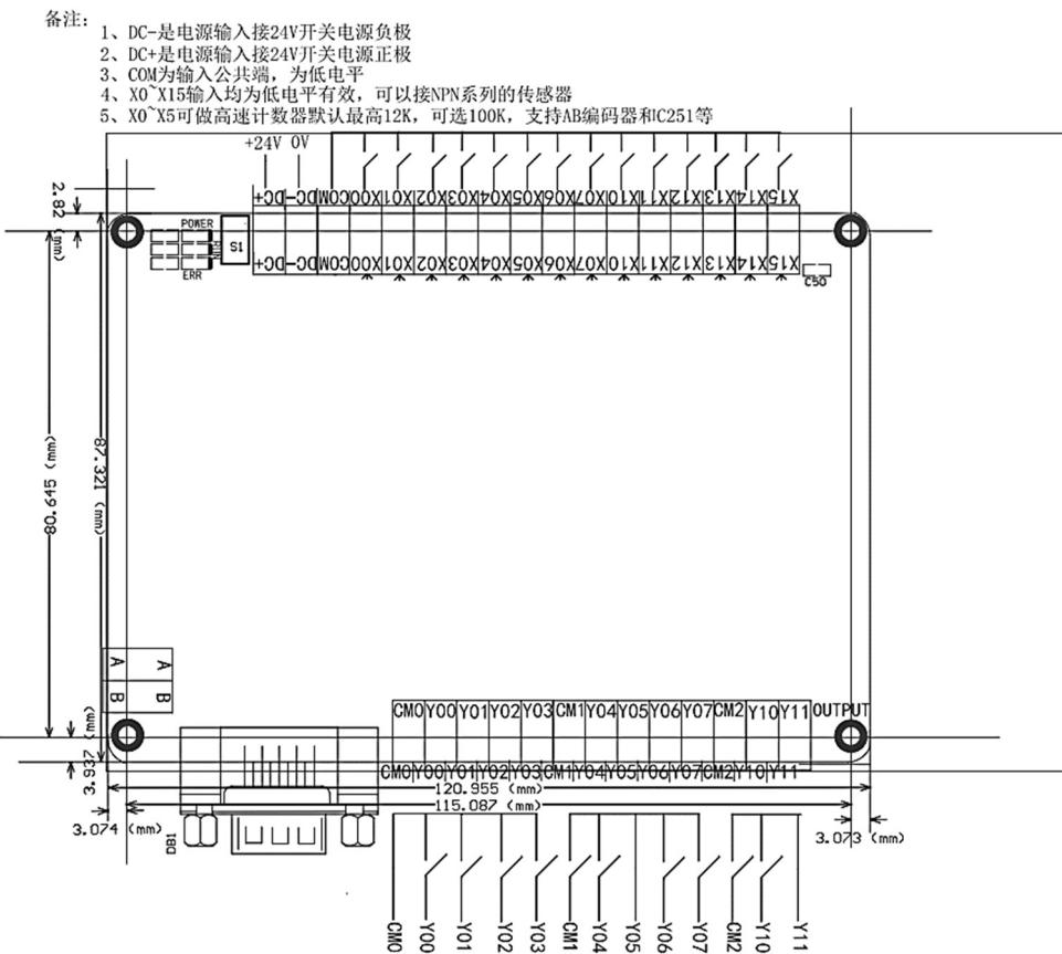
Slika 1.8 Prikaz blok sheme FX1N-32MR PLC-a prema proizvođaču
