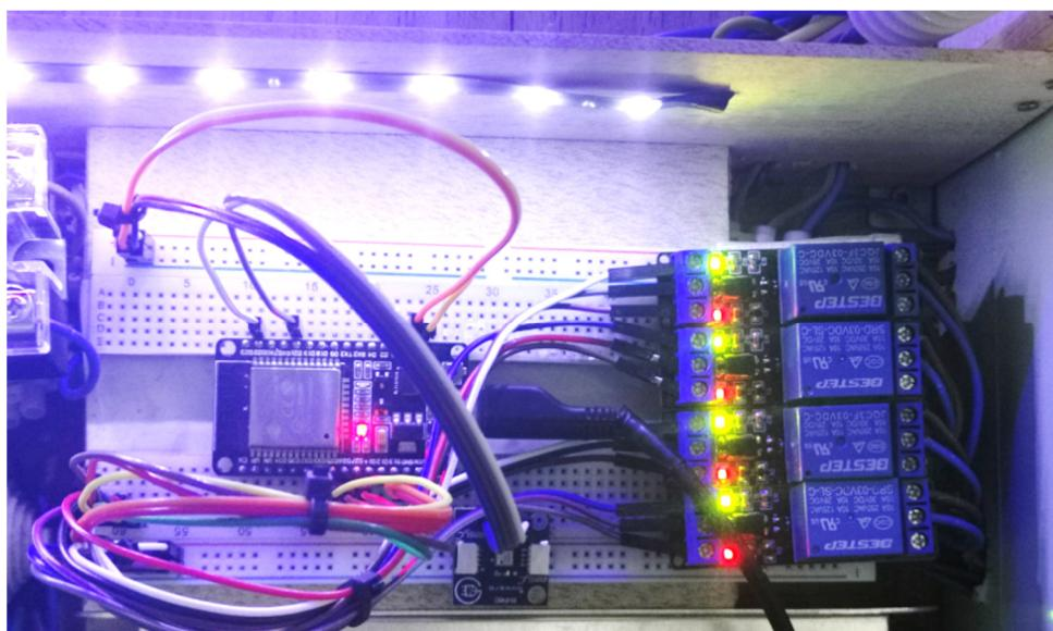
Slika 5.2 Prikaz ESP32 te BMP180 senzorike sa Arduino relezima
