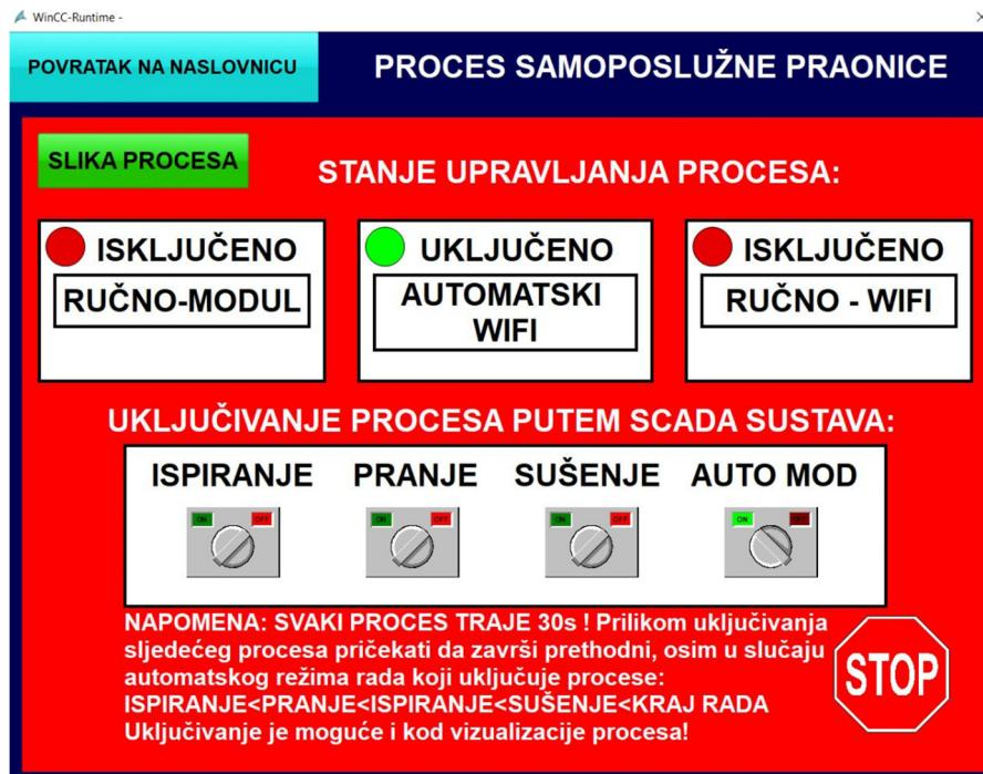
Slika 2.35 Prikaz stanja upravljanja prilikom simulacije automatskom rada
