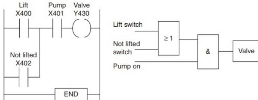
Slika 1.7 Primjer programiranja Ladder-om (lijevo) te FBD-om(desno) [4]
