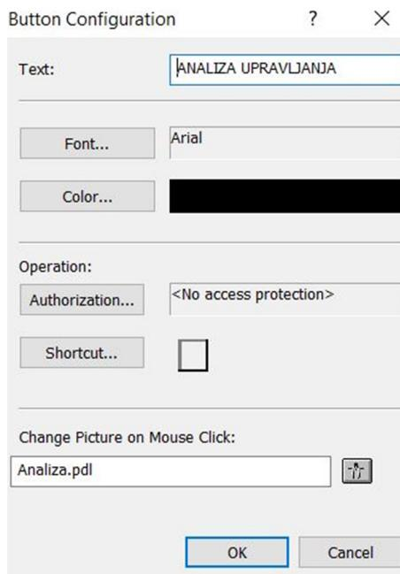
Slika 2.21 Prikaz konfiguracijskog prozora za definiranje tipke
