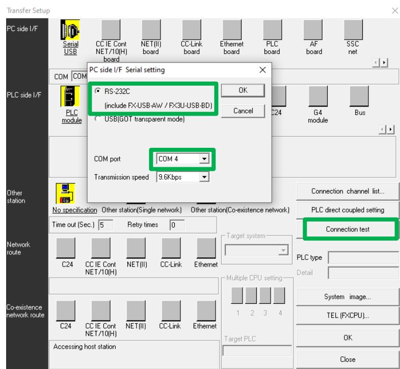
Slika 1.12 Prikaz izgleda konfiguracije povezivanja sa FX1N-32MR
