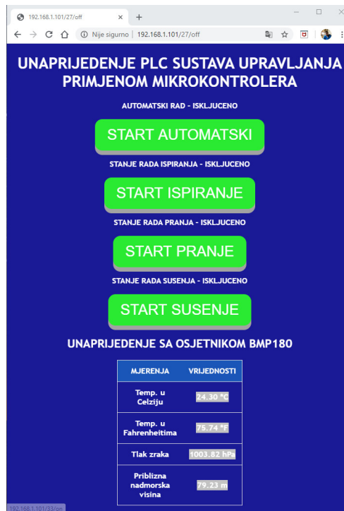
Slika 3.13 Prikaz ažuriranog sučelja unaprijeđenog osjetnikom BMP180
