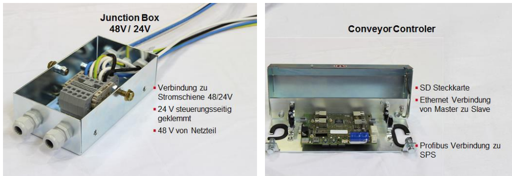
Slika 4.12 Osnovno dijelovi KDR sustava [2]
