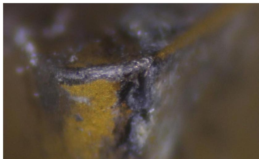
Slika 50. Plastična deformacija vrha rezne oštice 3
