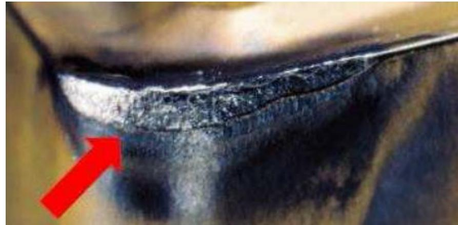
Slika 9. Trošenje na stražnjoj površini alata [2]
