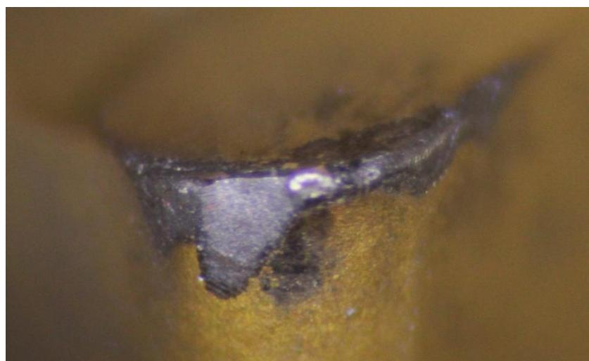
Slika 46. Nastalo trošenje stražnje površine rezne oštice 1
