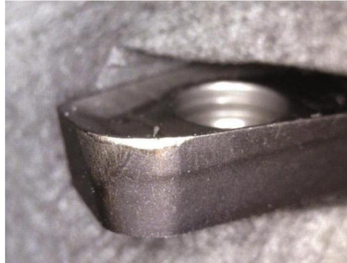
**Slika 28.** Trošenje radijusa nosa [21]
