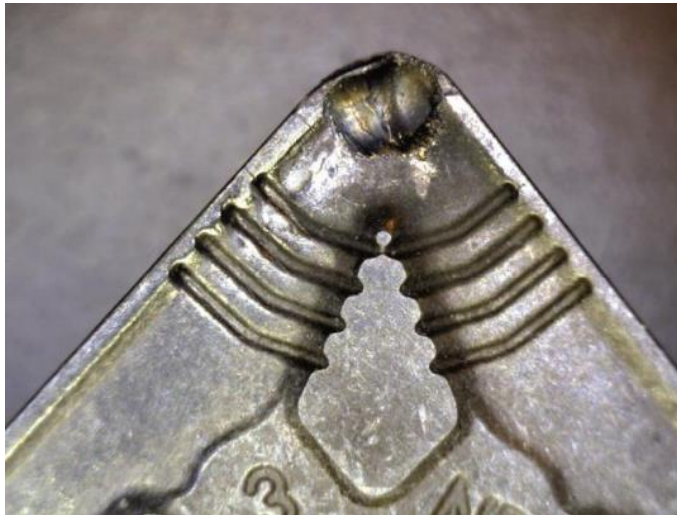
Slika 25. Trošenje gdje se stvara krater [21]
