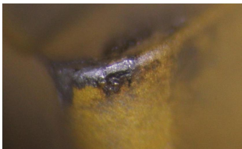
Slika 48. Zarezno trošenje rezne oštice 2
