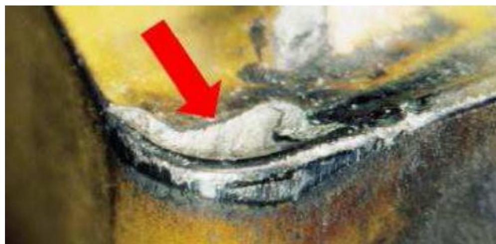
Slika 10. Krater na reznoj pločici [2]
