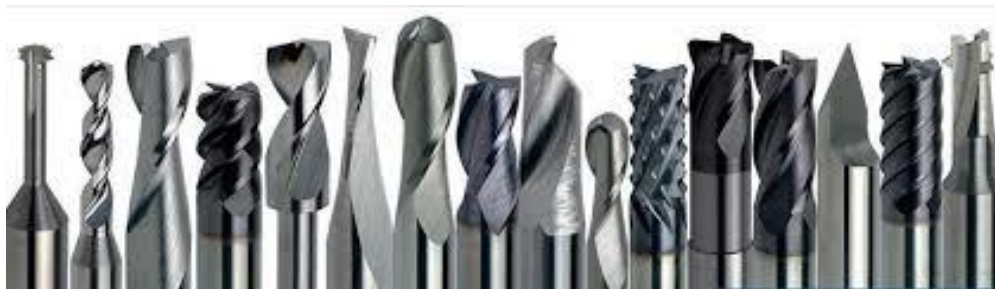
Slika 19. Glodala iz jednog materijala [18]
