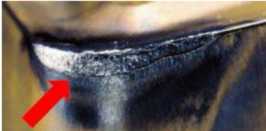
Slika 9. Trošenje na stražnjoj površini alata [2]
