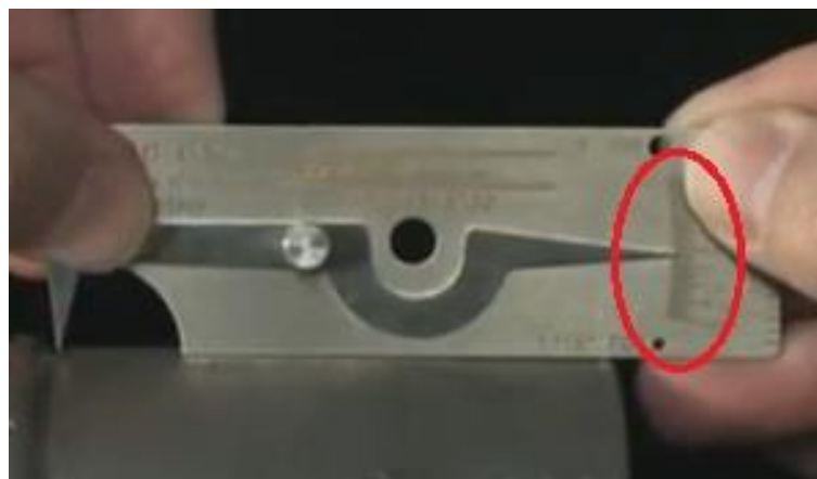
Slika 4.15. Mjerenje ugorina ili udubljenja v-wac
