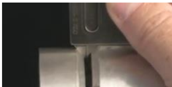
Slika 4.7. mjerenje skošenja pripremljenog žlijeba
