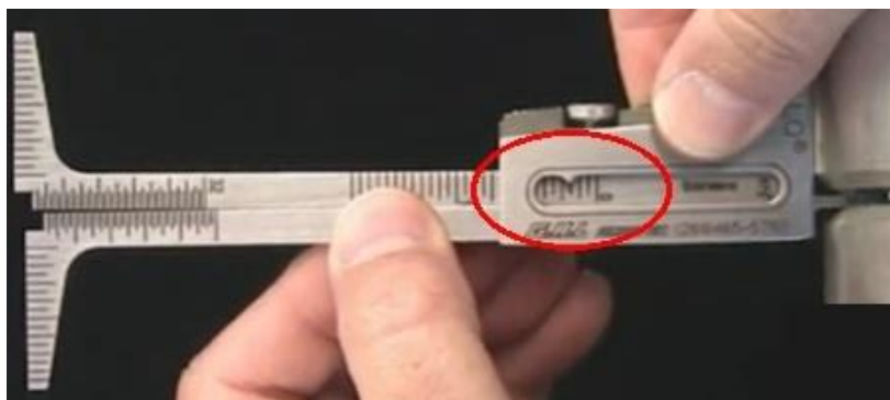
Slika 4.6. prikaz očitavanja debljine stijenke
