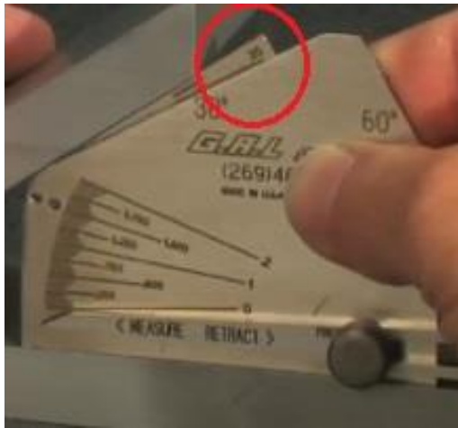
Slika 4.22 Prikaz mjerenja kuta pod kojim se nalaze ploče u kutnoj izvedbi spoja
