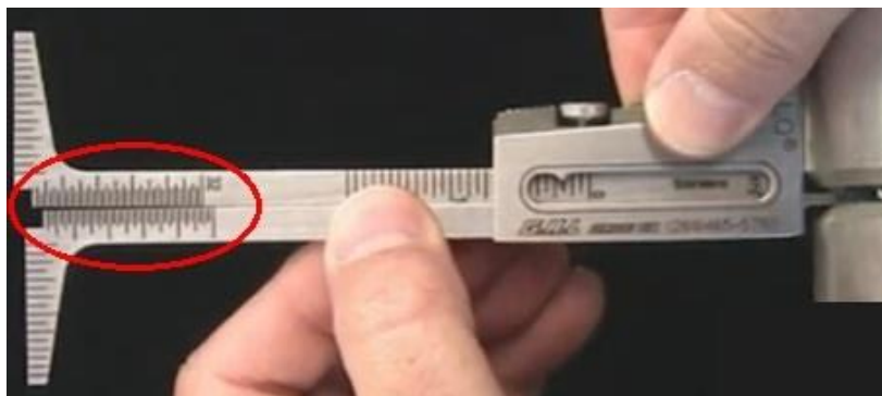
Slika 4.6. Mjerenje linearne posmaknutosti
