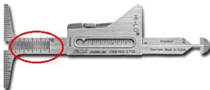
Slika 4.4. Prikaz očitavanja skale za nadvišenje zavara
