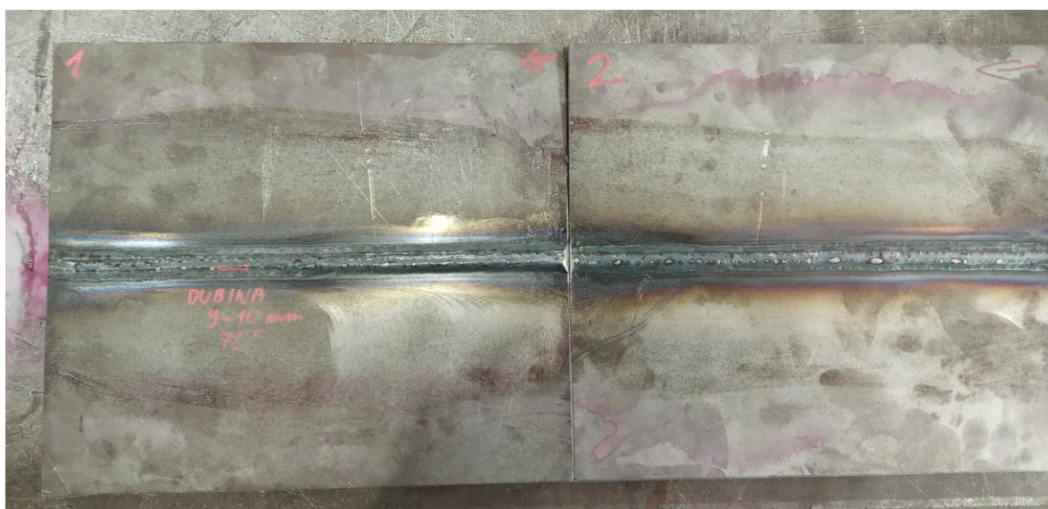
Slika 38. Uzorci nakon ultrazvučnog ispitivanja
