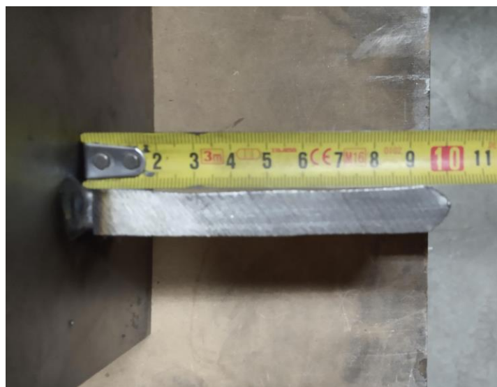
Slika 39. Nož za savijanje korišten prilikom poprečnog ispitivanja prijelomom
