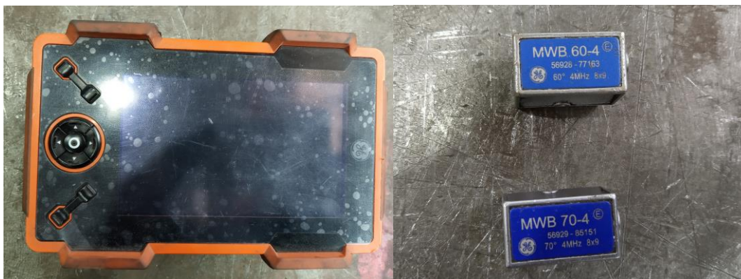
Slika 34. a) uređaj za ultrazvučno ispitivanje, b) kutne sonde od 60° i 70°
