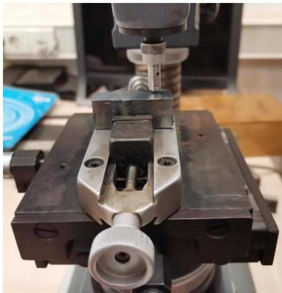
Slika 46. Utiskivanje indentora u površinu koja se ispituje
