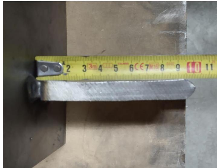
Slika 39. Nož za savijanje korišten priječnog ispitivanja prijelomom
