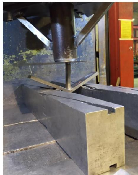
Slika 40. Opterećivanje uzorka nožem za savijanje na hidrauličkoj preši
