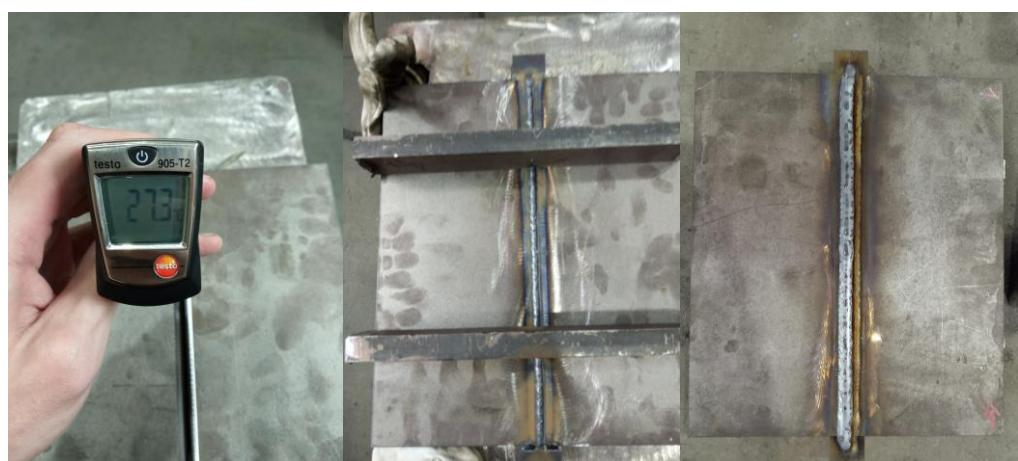
Slika 24. Kontrola uzorka 1 prije, tijekom i nakon zavarivanja
