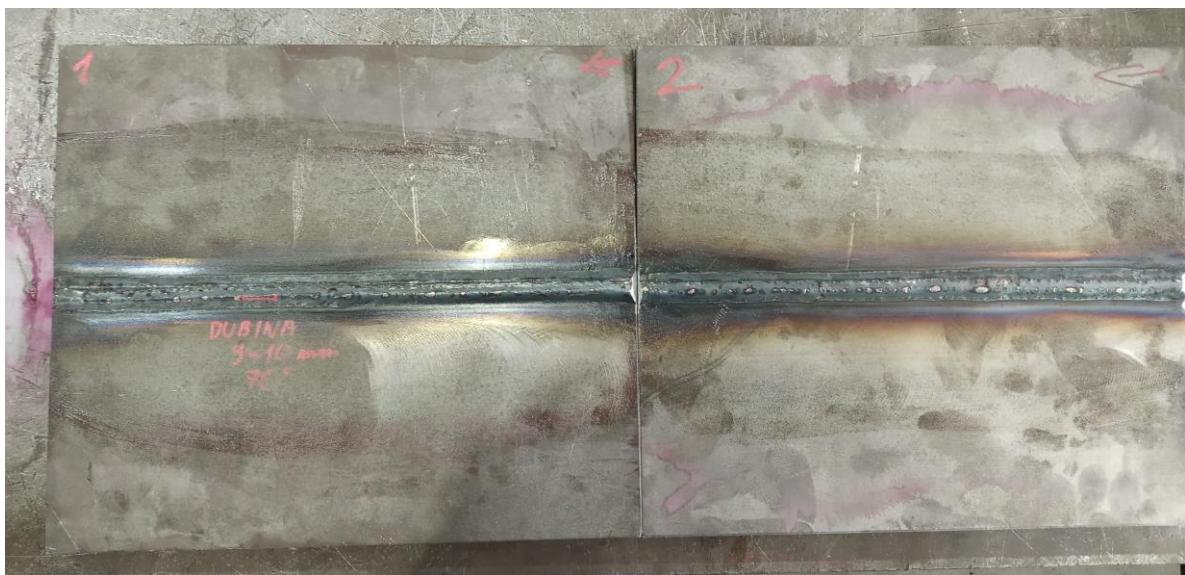
Slika 38. Uzorci nakon ultrazvučnog ispitivanja
