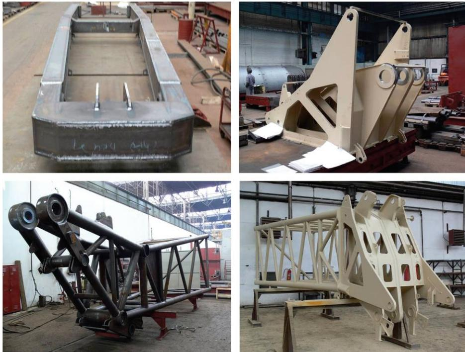
Slika 18. Dijelovi konstrukcija od S690QL u zavarenoj izvedbi u proizvodnji [18]
