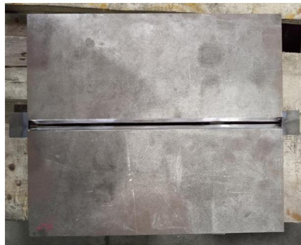
Slika 23. Pripremljene ploče zavarivanog uzorka sučeljenog spoja
