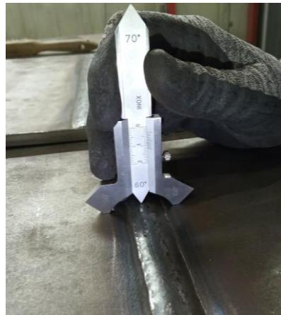
Slika 26. Ispitivanje dimenzija zavarenih uzoraka
