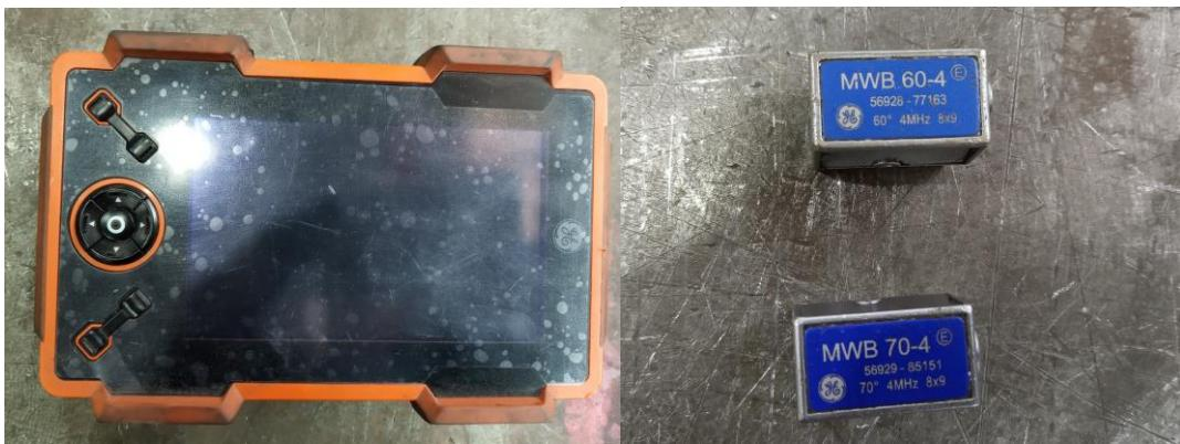
Slika 34. a) uređaj za ultrazvučno ispitivanje, b) kutne sonde od  $60^\circ$  i  $70^\circ$
