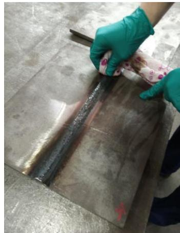
Slika 27. Čišćenje površine prije ispitivanja tekućim penetrantima
