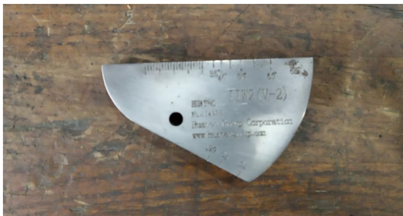
Slika 35. Kalibracijski blok K2
