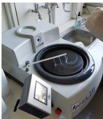
Slika 43. Uređaj za ručno poliranje Minitex 233
