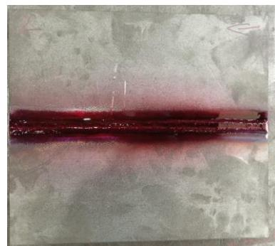
Slika 30. Nanesen crveni penetrant na površinu zavarenog spoja
