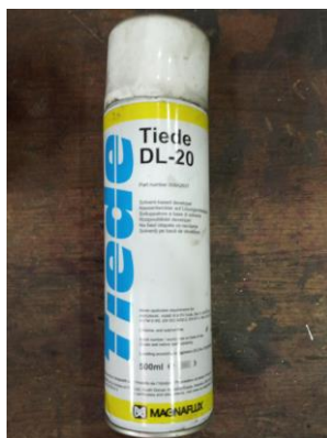
Slika 31 Razvijač Tiede DL-20
