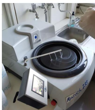
Slika 43. Uređaj za ručno poliranje Minitech 233
