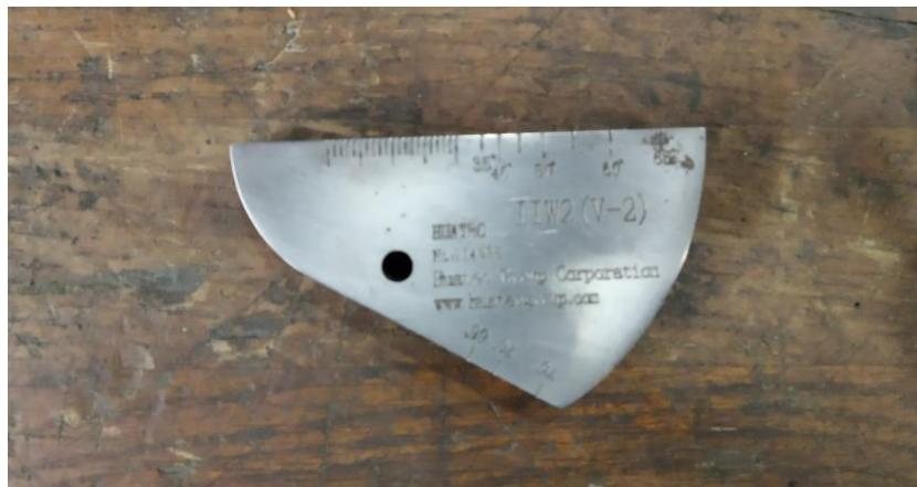
Slika 35. Kalibracijski blok K2
