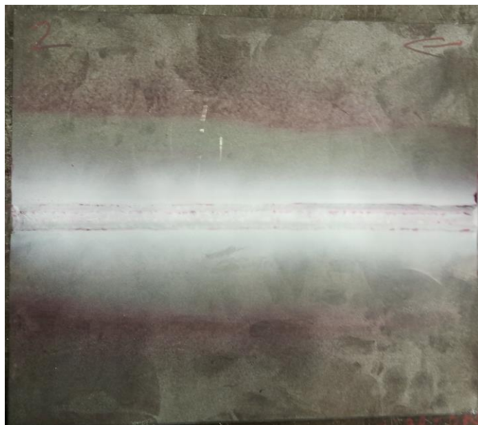
Slika 32. Nanesen razvijač na zavareni uzorak bez nedozvoljenih indikacija
