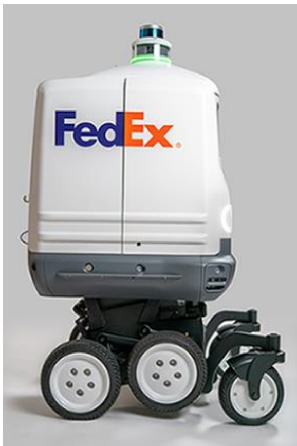
Slika 3.2 Autonomno dostavno vozilo tvrtke FedEx
