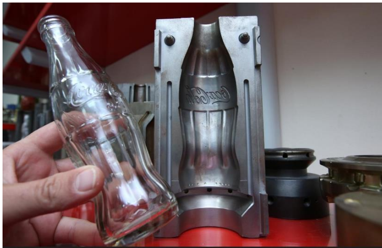
Slika 13. Izrada boce Coca – Cole u OMCO Croatia
