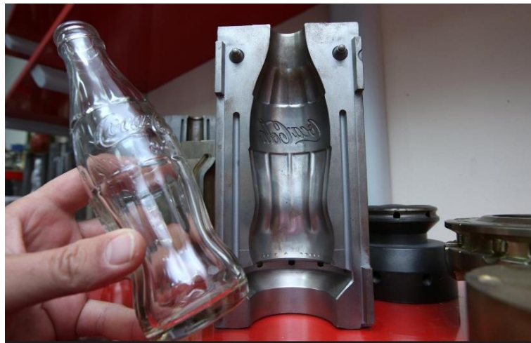
Slika 13. Izrada boce Coca – Cole u OMCO Croatia
