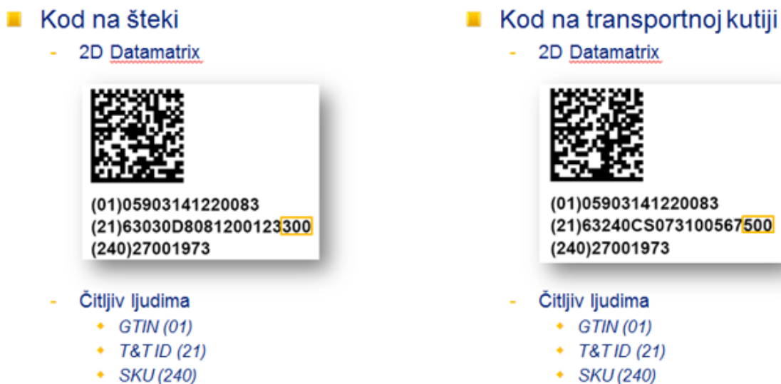
Slika 17. 2D Datamatrix kodovi na štekama i transportnim kutijama
