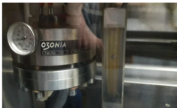
Slika 3.21. Čelija generatora ozona (vlastiti izvor)
