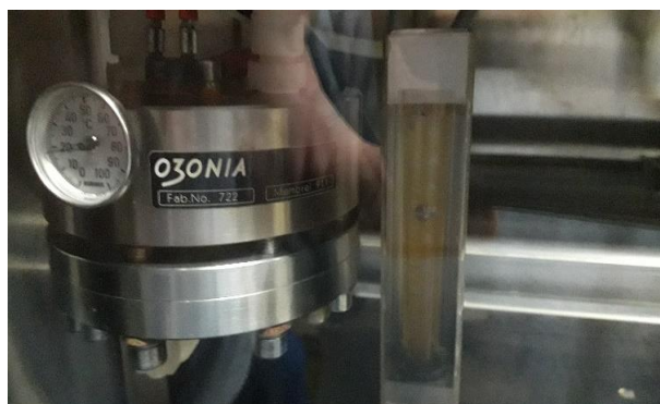
Slika 3.21. Čelija generatora ozona (vlastiti izvor)
