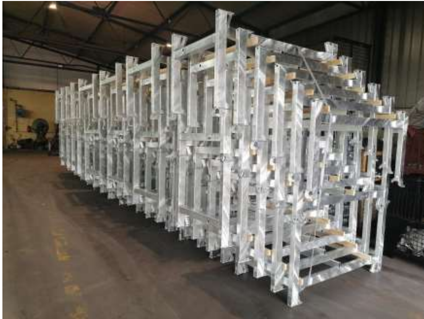
Slika 23 - Izgled proizvoda X nakon vrućeg pocinčavanja
