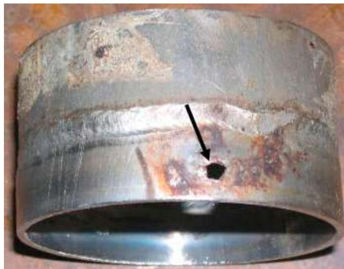
*Slika 2 - Točkicom je označena lokalna korozija na metalnom elementu*
