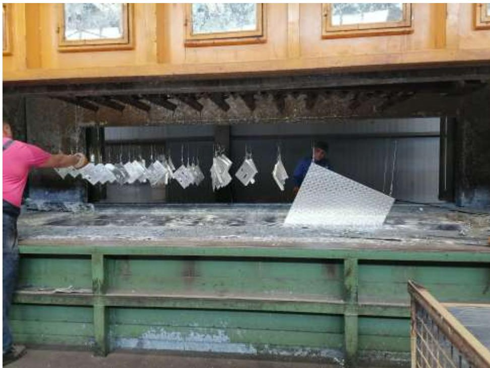
Slika 17 - Ustanjanje komada u rastaljeni Zn
