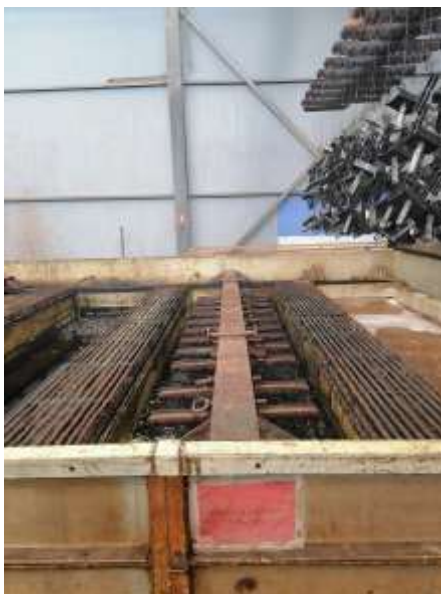
Slika 14 - Kada sa HCl
