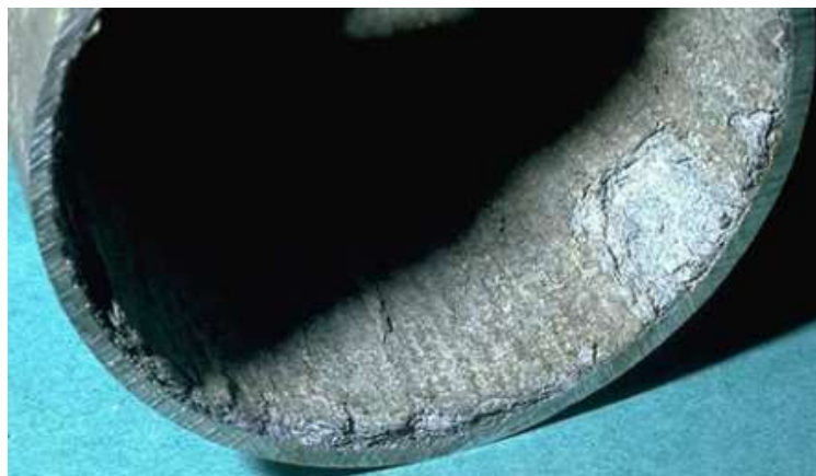
Slika 4 - Primjer selektivne korozije
