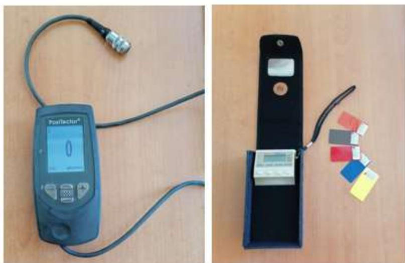
Slika 24 - Uređaji za mjerjenje debljine prevlake Zn
